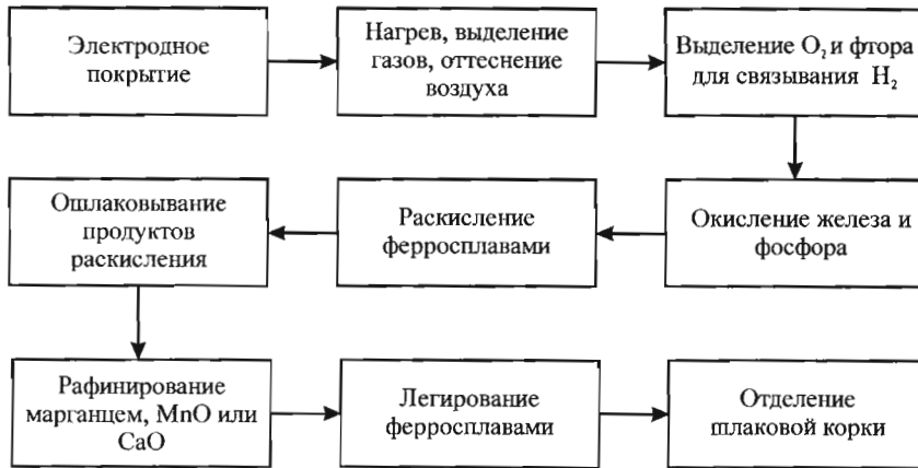
Рис. 1.27. Алгоритм процессов при сварке электродами с покрытиями
