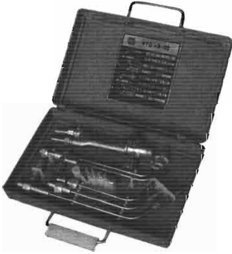
Рис. 9.11. Комплект для сварки и резки КГС-1
