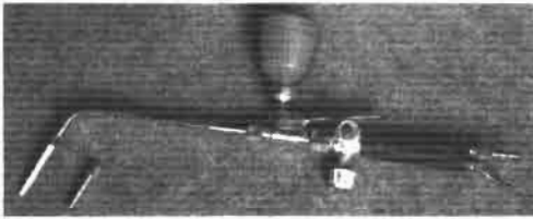
Рис. 9.2. Горелка ГН-2 для газопорошковой наплавки
