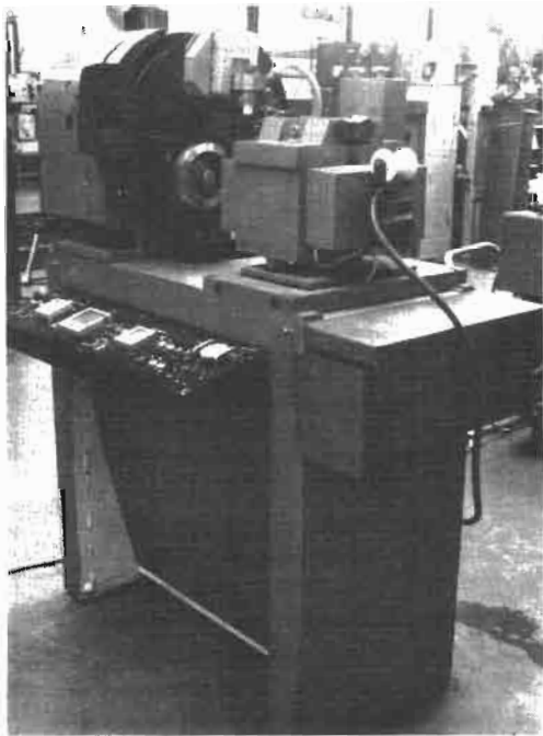
Рис. 4.60. Установка СА-460 для сварки поворотных и неповоротных стыков труб диаметром 8...57 мм колеблющимся неплавящимся электродом с присадкой
