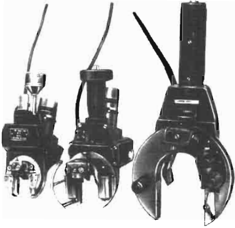
Рис. 4.49. Головки ОДА-1, ОДА-2 и ОДА-3 для орбитальной сварки последовательным проплавлением и с автоопрессовкой труб диаметром 8...26, 20...42 и 42...76 мм соответственно
