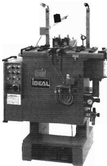
Рис. 5.85. Стыковая машина BAS-052 (фирма «Ideal») для сварки ленточных пил
