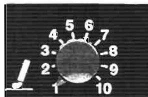
Рис. 4.129. Потенциометр для регулирования динамических характеристик дуги
