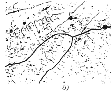
Рис. 13.6. Микроструктура зоны сплавления (линия 1 – 1) перлитной стали П с аустенитным швом А на участке ХТ типа «отрыв», проходящей преимущественно по аустенитной стали (а) и микроструктура центра аустенитного шва с четко выраженной границей зерна на фоне дендритной структуры (б). Увеличение 600 \times
