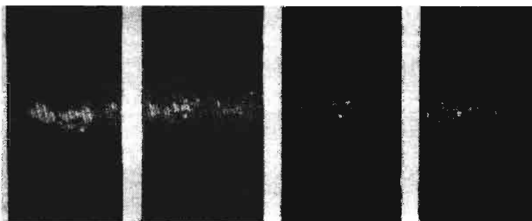
Рис. 16.11. Вольфрамовые включения в швах сварных соединений алюминиевого сплава (рентгеновский снимок)
