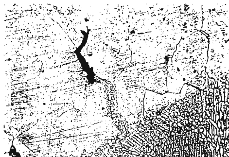
Рис. 10.29. ГТ по ликвационным прослойкам в ЗТВ при аргонодуговой сварке сплава ХН67ВМТЮ толщиной 30 мм. Увеличение 200 \times
