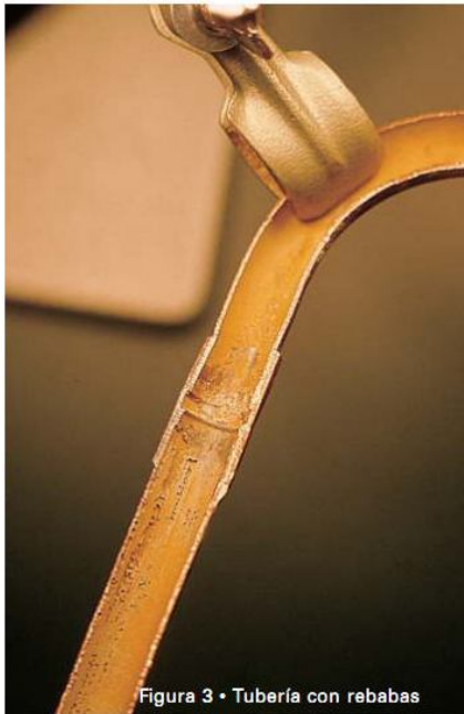
Figura 3 • Tubería con rebabas
