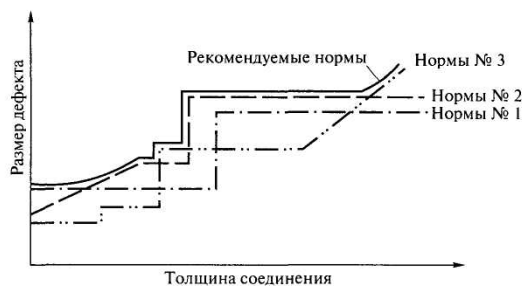
Рис. 3.13. Пример обоснования норм допустимости дефектов на основе применения различных апробированных норм, где № 1, № 2 и № 3 - варианты норм допустимости дефектов
