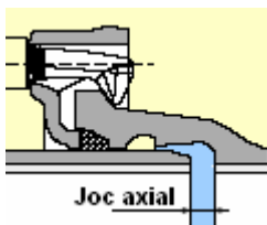
Fig. 3.50 Jocul axial al îmbinării mecanice EXPRESS
