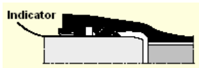
Fig.7.88 Verificarea poziției garniturii de etanșare cu indicatorul
