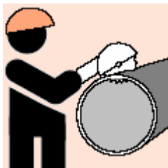
Fig.7.1 Tăierea țevii cu polizorul cu disc (flex)
