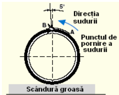
Fig.7.125 Poziția reperelor pentru sudură
