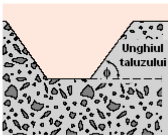
Fig.5.29 Executarea pereților tranșeei sub unghiul \Phi
