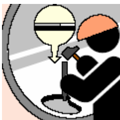
Fig.7.17 Îndepărtarea zonei care conține defecte
