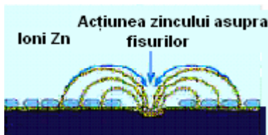
Fig.4.3 Acțiunea zincului asupra fisurilor
