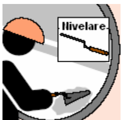
Fig.7.20 Aplicarea stratului de mortar cu mistria
