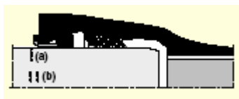
Fig.7.87 Poziția marcajelor în timpul asamblării îmbinării
