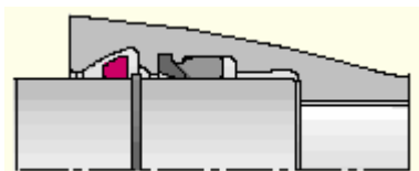
Fig.7.104 Poziția capătului neted în interiorul mufei
