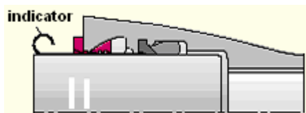
Fig.7.118 Verificarea poziției garniturii de etanșare cu indicatorul
