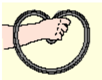
Fig.7.50 Strângerea garniturii în formă de inimă
