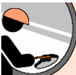
Fig.7.18 Îndepărtarea urmelor de praf cu peria de sârmă
