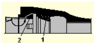
Fig.7.85 Poziția garniturii de etanșare și a inelului de blocaj
