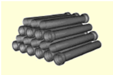
Fig.6.20 Depozitarea sub formă de stivă a țevelor mufă – capăt neted
