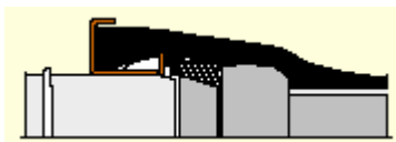
Fig.7.78 Introducerea capătului neted în inelul de blocaj
