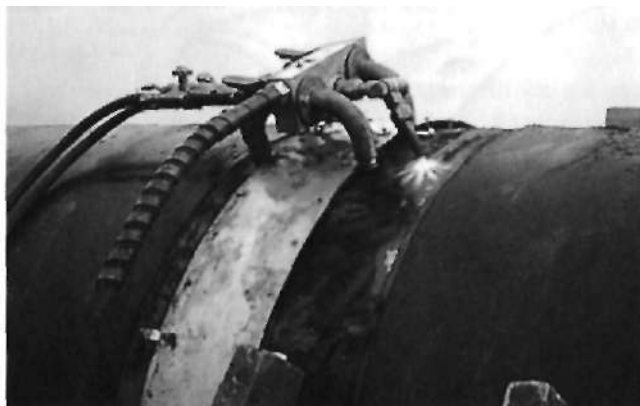
Рис. 2.11. Аппарат машинной резки фирмы CRC Evans
