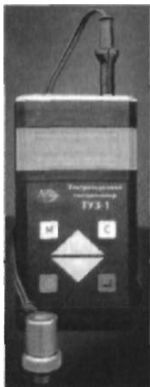
Рис. 6.7. Ультразвуковой толщиномер ТУЗ-1
