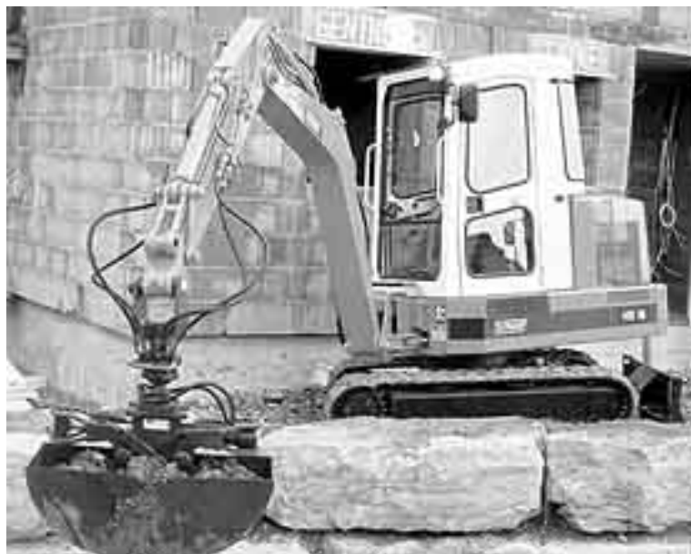
Рисунок 3. Гусеничный мини-экскаватор модели HR16 фирмы "Karl Schaeff GmbH & Co".
