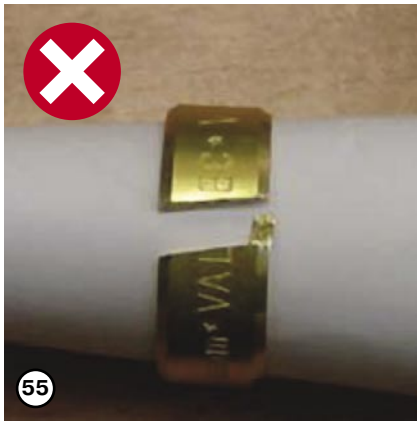
«Сухарь» на разрезе не должен иметь заусенцев
