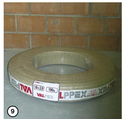
9 Если бухта металлопластиковой трубы доставлена в помещение с мороза, ей дается возможность вылежаться в течение 5 часов при температуре не менее 10°C
