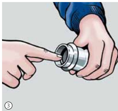
Se verifică poziția corectă a garniturii de etanșare.
