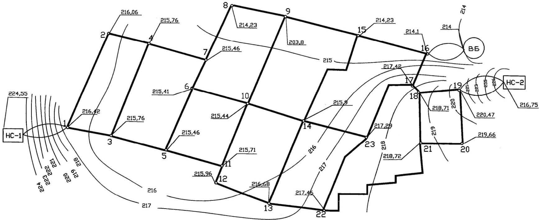
Рис. 5.4. Карта пьезолиний на случай максимального транзита в башню
