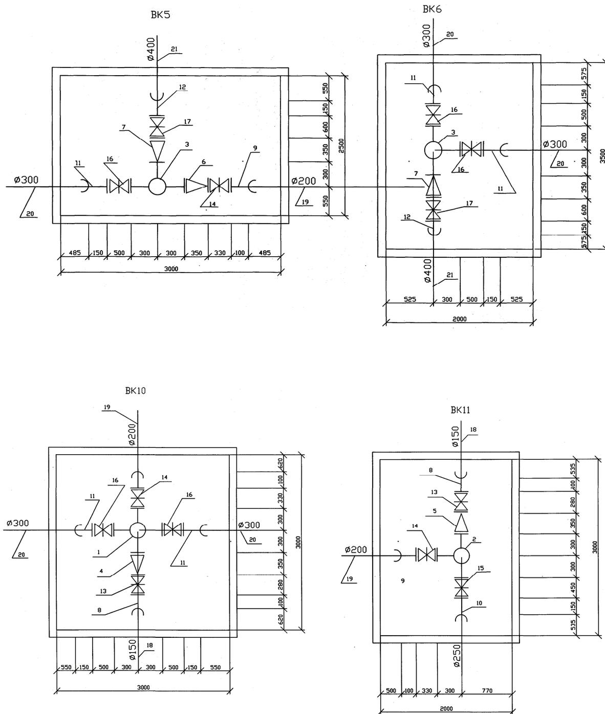
Рис. 8.1. Детализовка водопроводных колодцев (кольцо №5).
