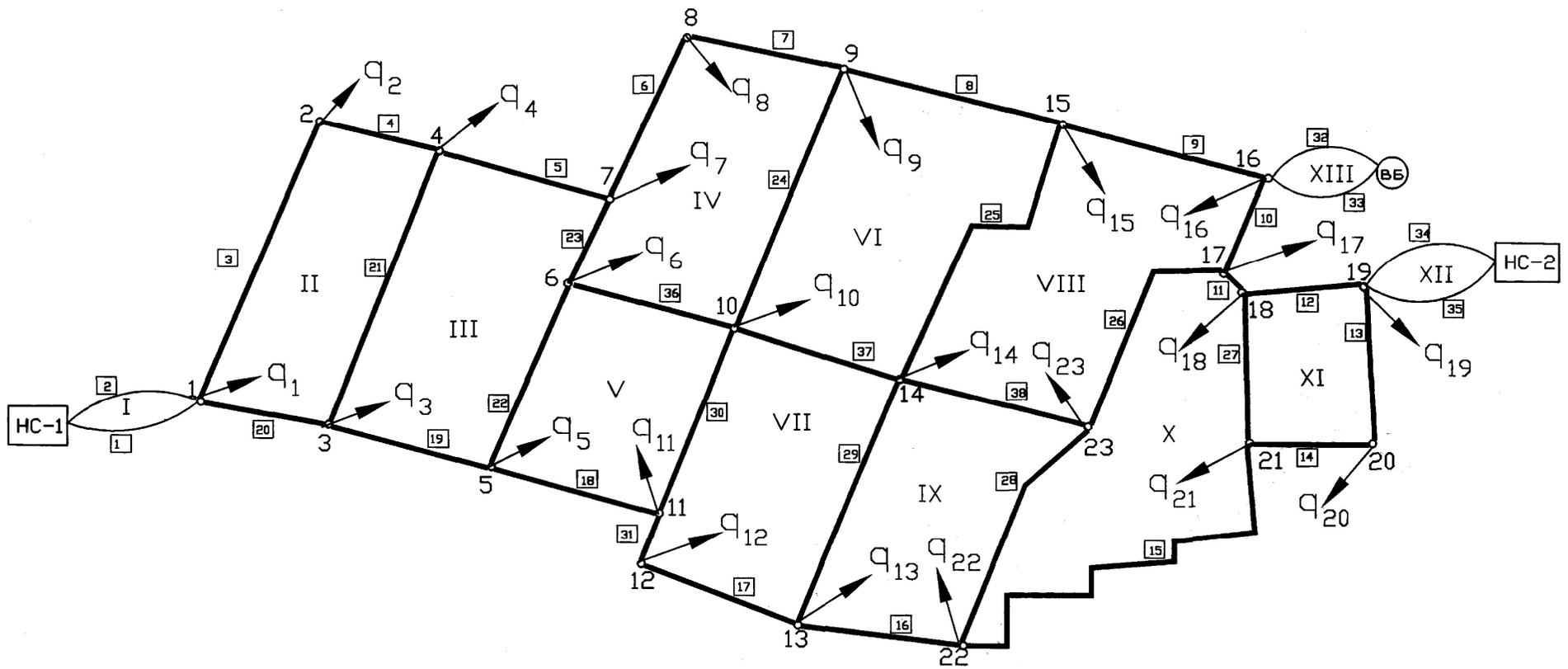
Рис. 3.3. Расчетная схема водопроводной сети I очереди строительства
