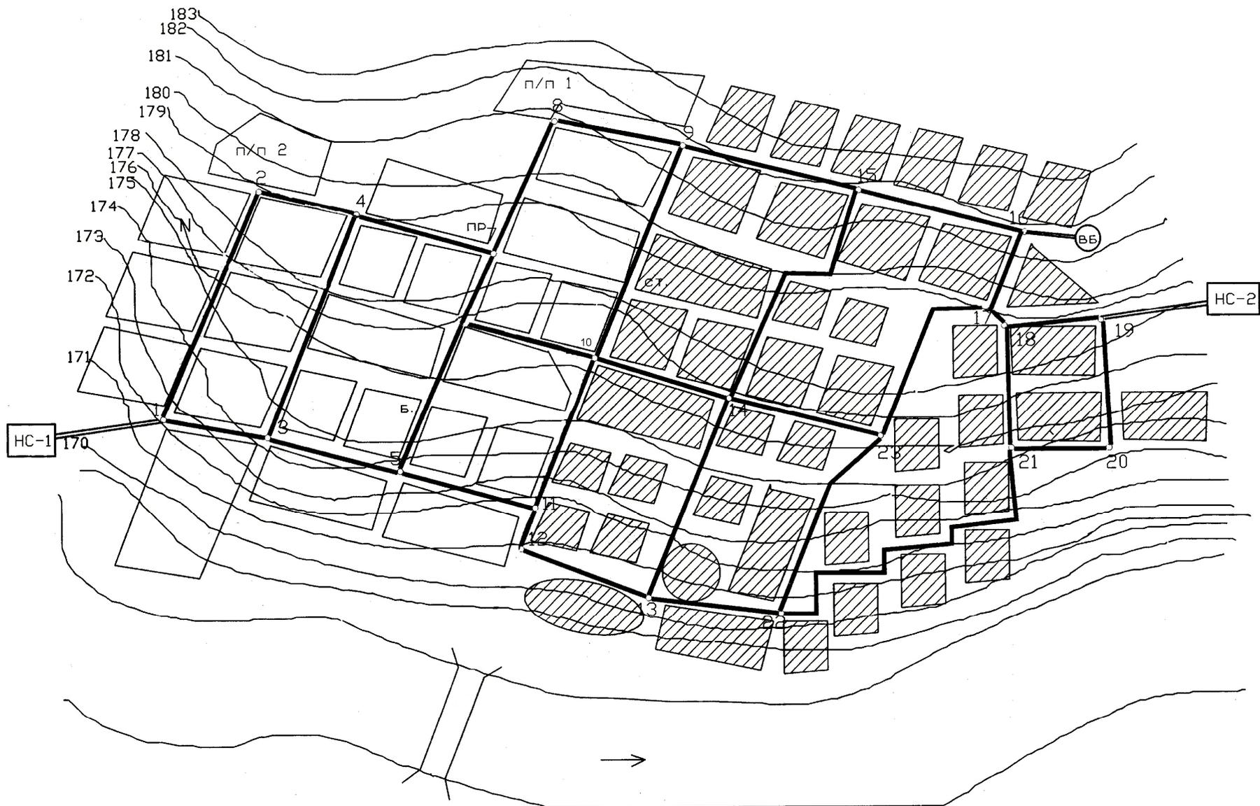
Рис. 3.1. Трассировка водопроводной сети I очереди строительства
