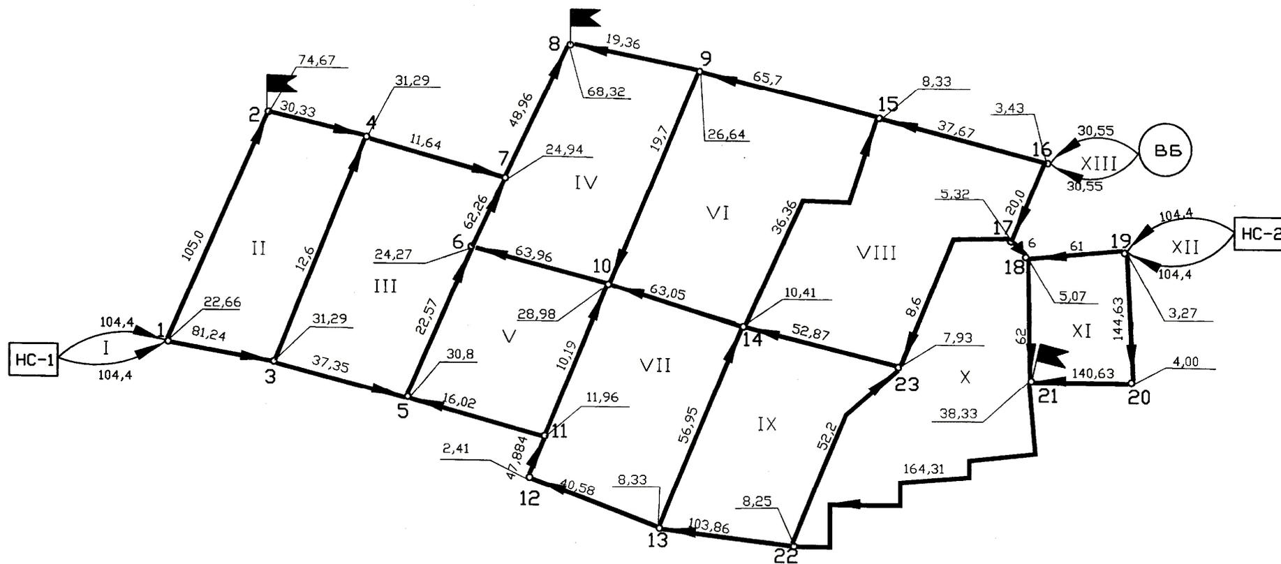
Рис. 4.1. Предварительное потокраспределение на случай максимального водопотребления с учетом пожара
