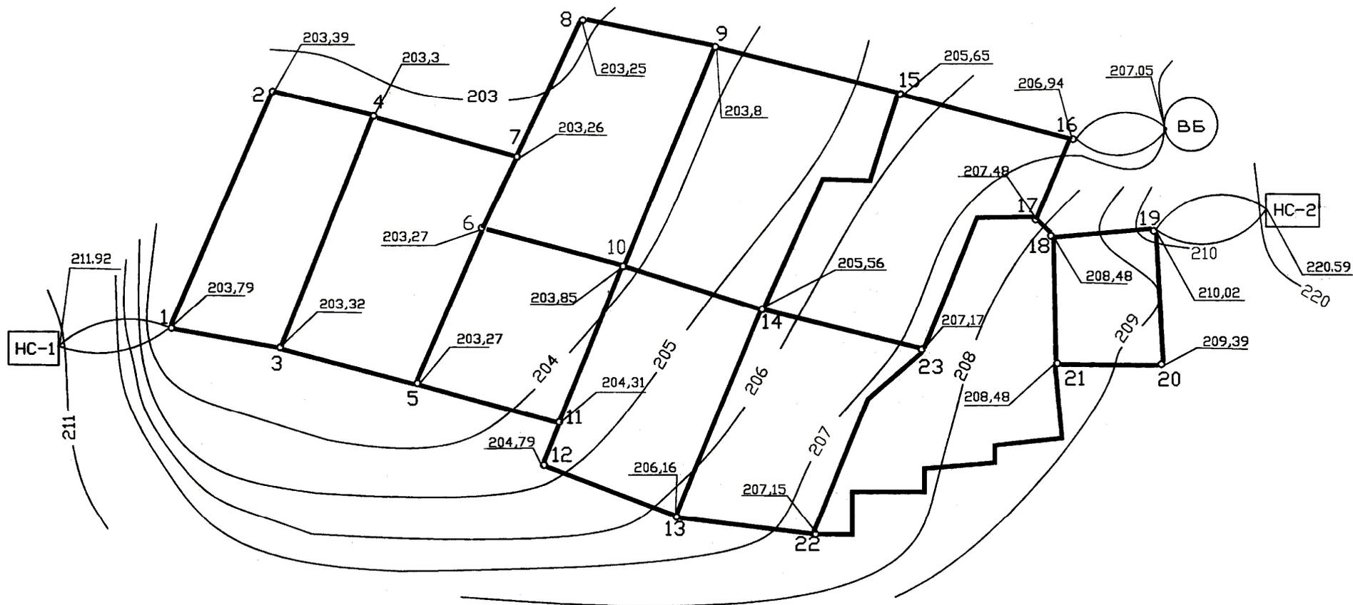
Рис. 3.6. Карта пьезолиний на случай максимального водопотребления
