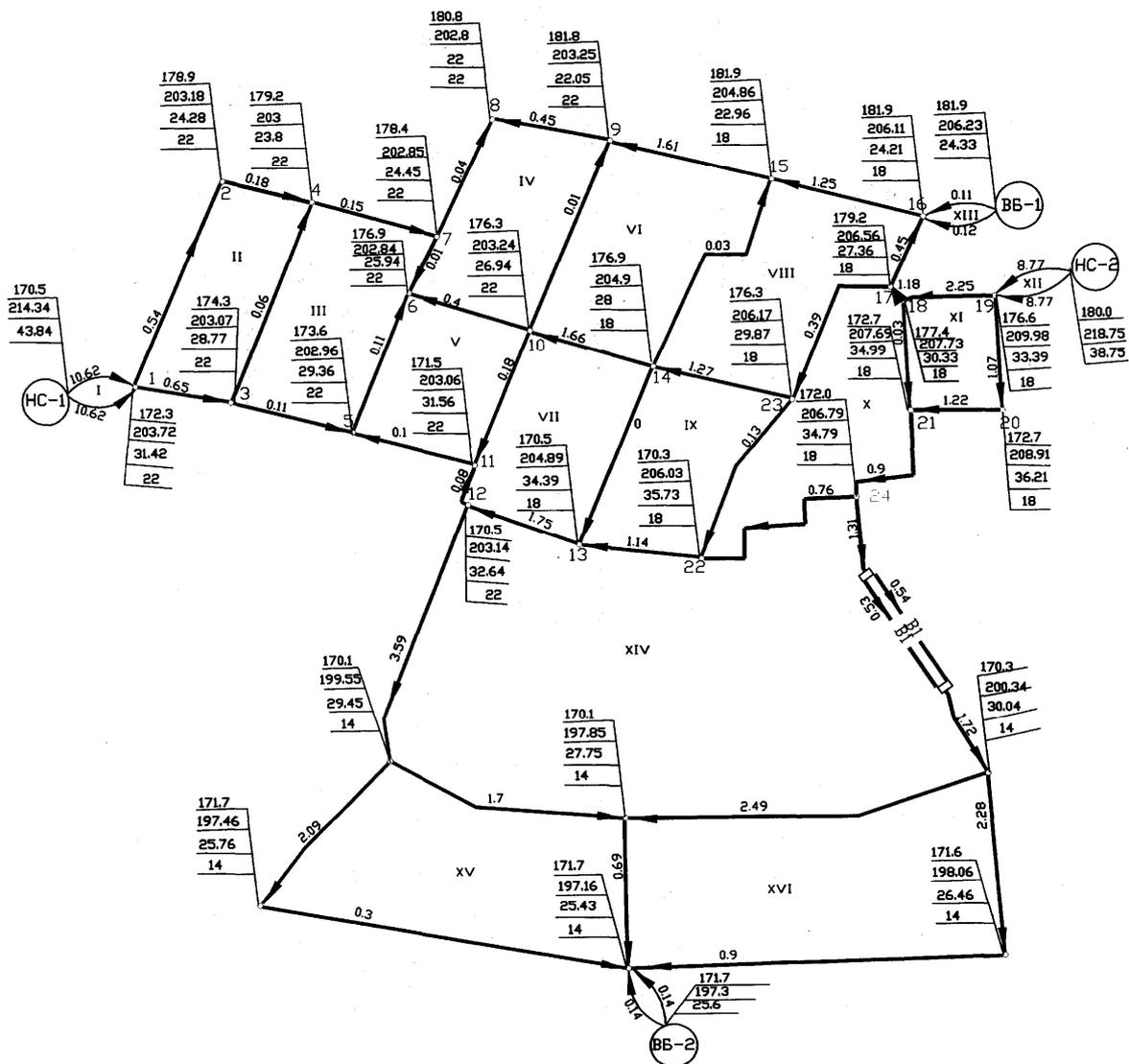
Рис. 6.3. Результаты расчета пьезометрических отметок и свободных напоров.
