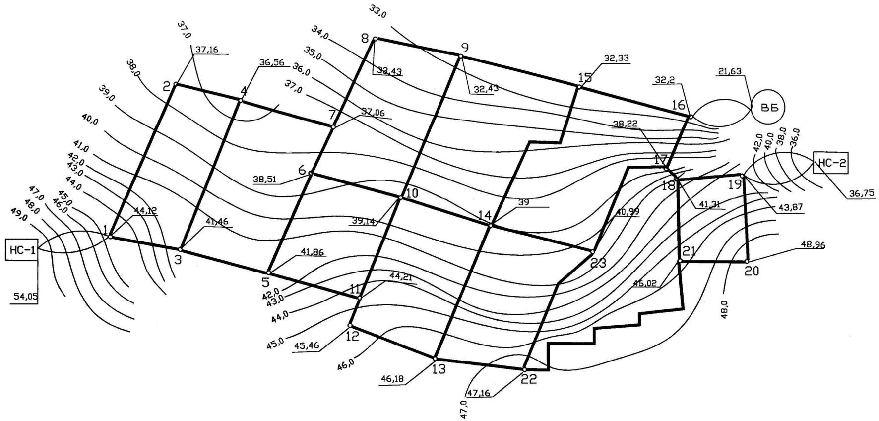
Рис. 5.5. Карта свободных напоров на случай максимального транзита в башню
