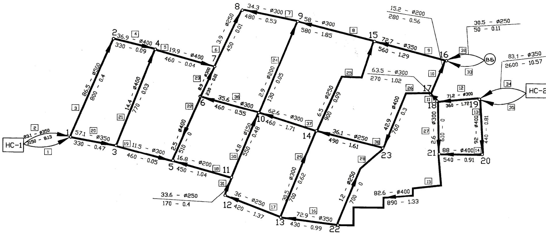
Рис. 3.4. Результаты гидравлического расчета для случая максимального водопотребления
