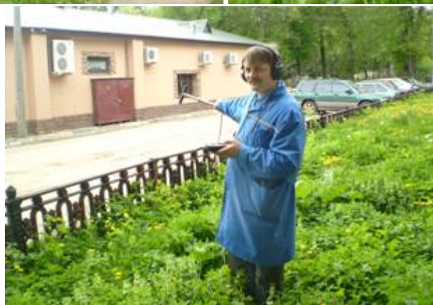
Обнаружены три трассы прокладки силовых кабельных линий. Два кабеля связывают, ВРУ-0,4 детского сада с ЩР-0,4 соседних учреждений.
