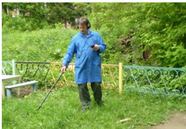
Обнаружены три трассы прокладки силовых кабельных линий. Два кабеля связывают, ВРУ-0,4 детского сада с ЩР-0,4 соседних учреждений.
