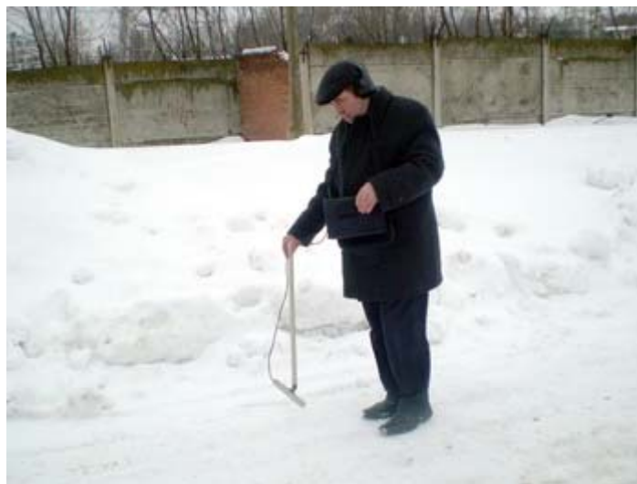
Точно определяем ось трубопровода методом минимума и глубину его залегания тригонометрическим методом.
