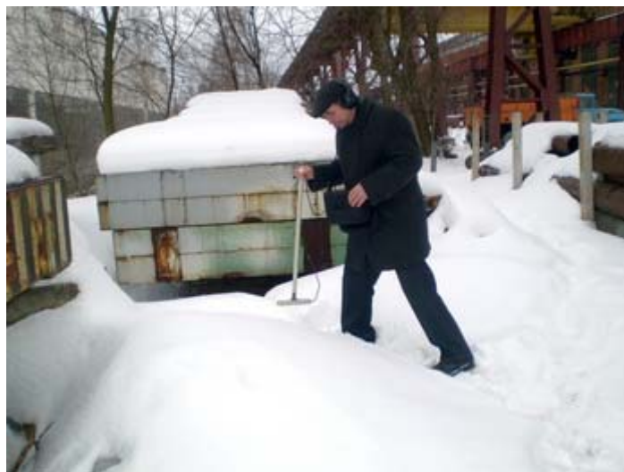
Проводим трассировку. Лежащий в непосредственной близости газопровод и металлические конструкции не внесли существенных искажений.
