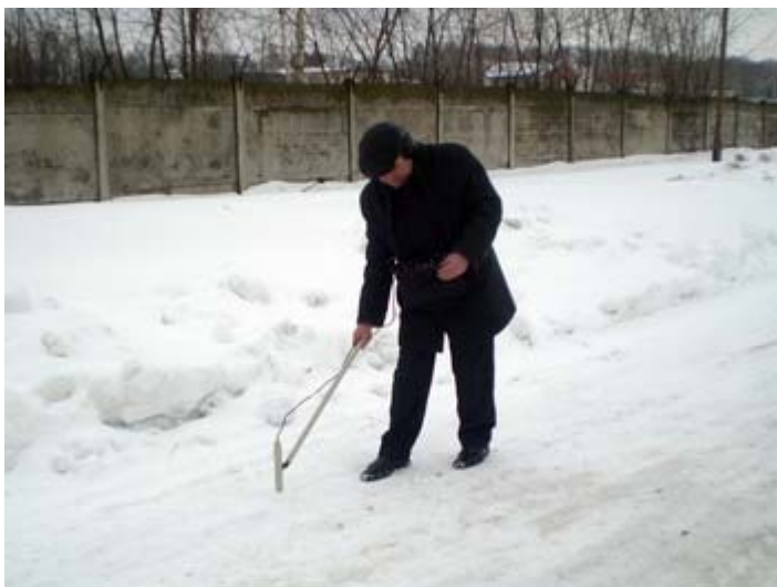
Точно определяем ось трубопровода методом минимума и глубину его залегания тригонометрическим методом.
