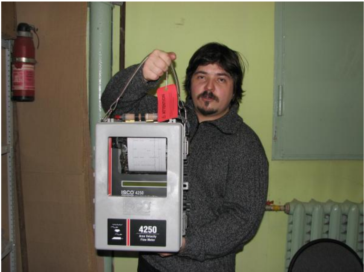
Расходомер для безнапорных каналов ISCO 4250, реализующий метод «площадь-скорость»
