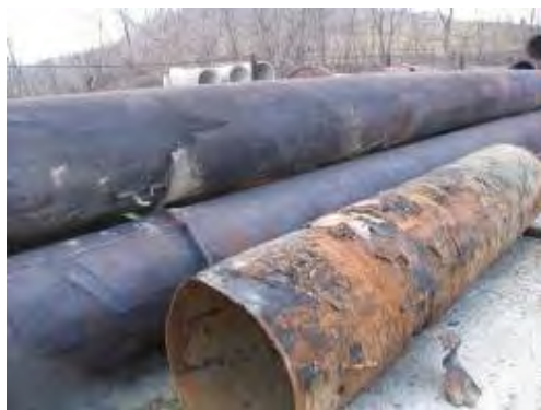
Figura 2.10-27: Conducte oțel corodate
