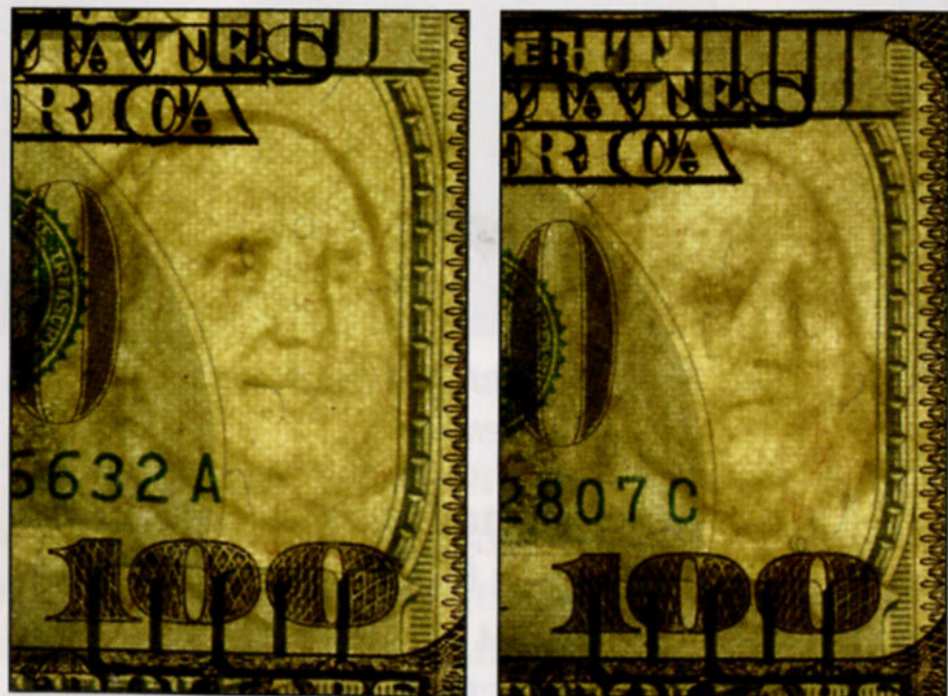
Рис. 10. Различный вид водяного знака на подлинных банкнотах
