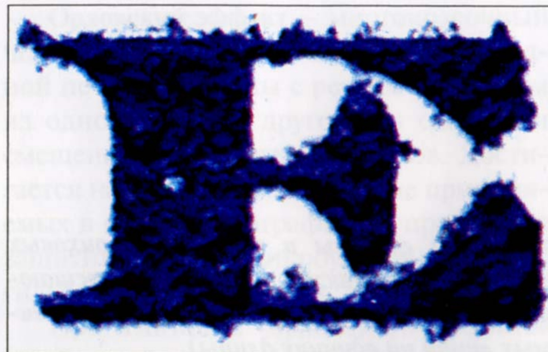
Рис. 28. Пример металлографского оттиска. Хорошо видно выдавливание краски за границу оттиска и образование «усиков»
