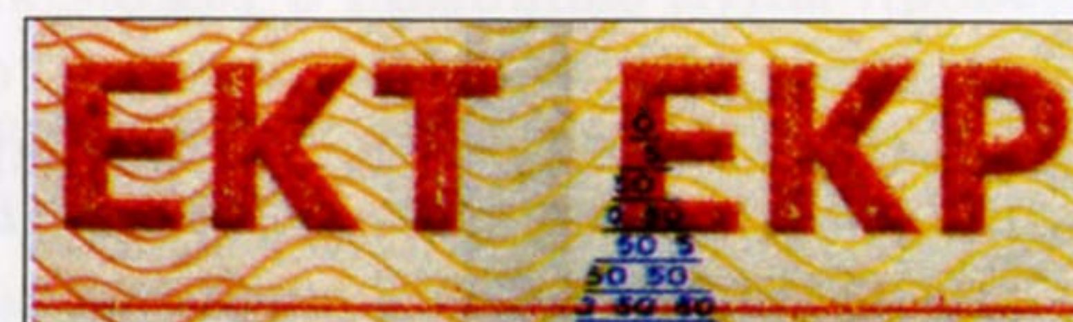
Рис. 30. Имитация металлографской печати «присыпкой» полимерным порошком:
