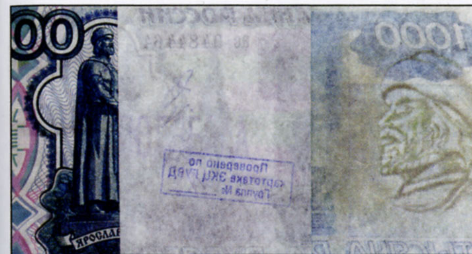
Рис. 12. Имитация водяного знака на внутренней стороне второго слоя
