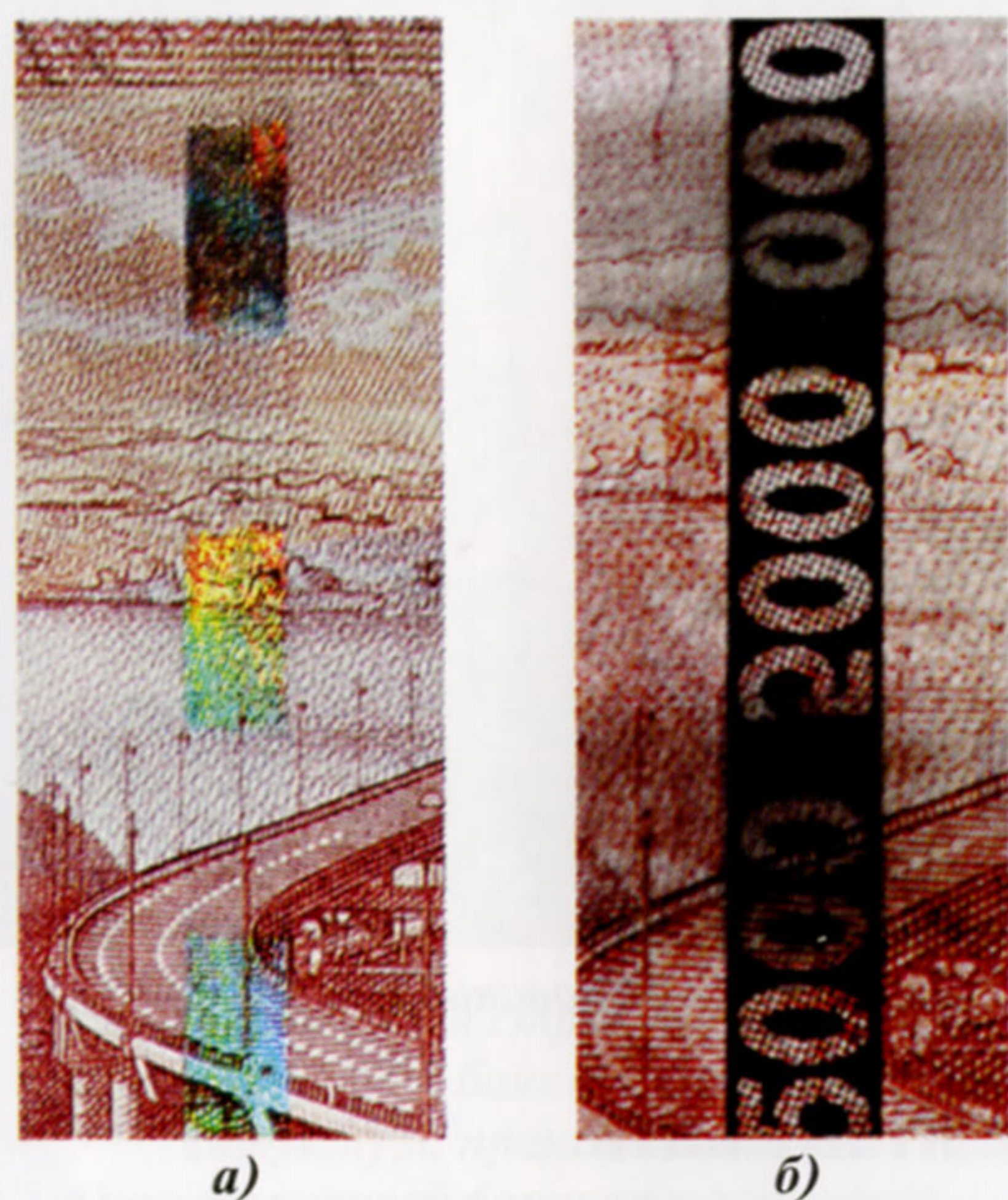
Рис. 15. Защитная нить ныряющего типа с голографическим покрытием: а) в отраженном свете; б) в проходящем свете
