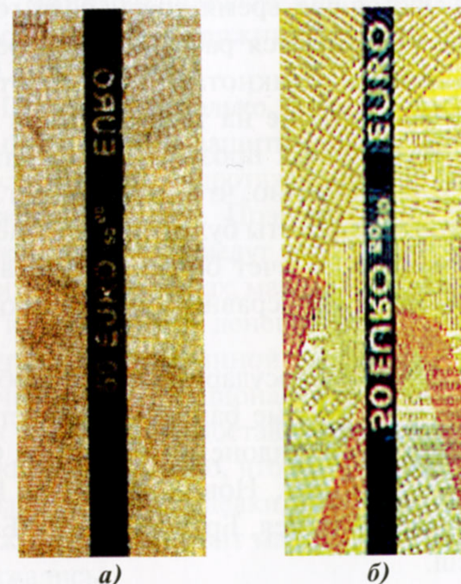
Рис. 18. Надпечатка текста при имитации защитной нити: а) фальшивая; б) подлинная
