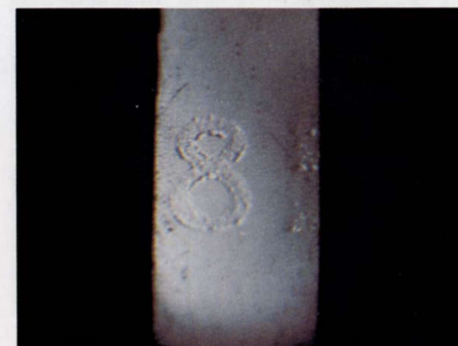
Рис. 43. Визуализация магнитной краски серийного номера на банкноте в 20 евро
