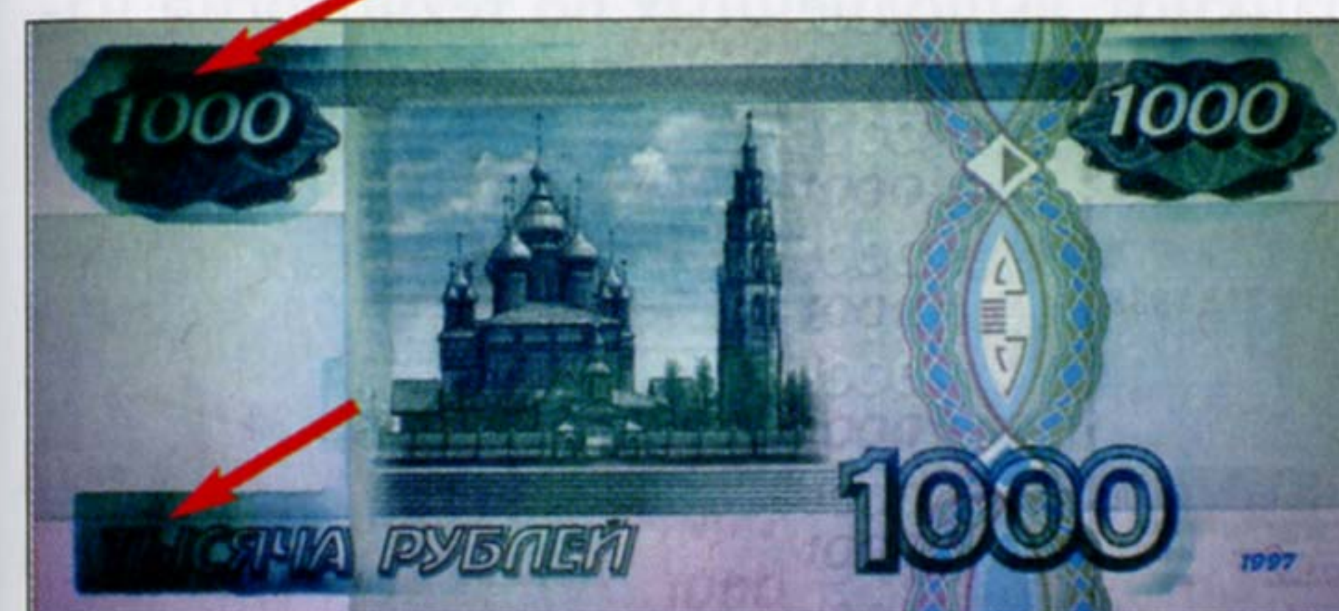
Рис. 32. Следы краски, не удаленной с пробельных элементов печатной формы
