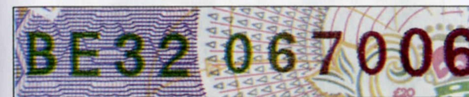
Рис. 42. Серийный номер с ирисовым раскатом на фунтах стерлингов Банка Англии
