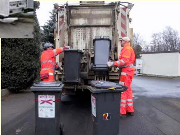
Vehicul autocompactor - încărcător spate
