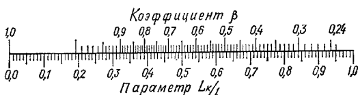
Рис. 9.10. Номограмма для определения коэффициента \beta
