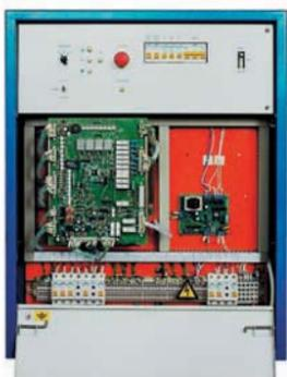
В системе управления лифтом СУЛ реализован принцип распределенной микропроцессорной системы сбора и обработки информации.
