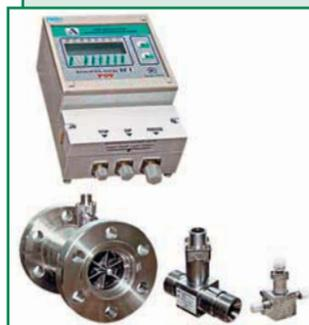
Расходомер-счетчик турбинный РСТ предназначен для измерения объема и объемного расхода жидких сред с вязкостью до 100 мм<sup>2</sup>/с (СТ), водоспиртовых растворов при технологических и коммерческих операциях.
