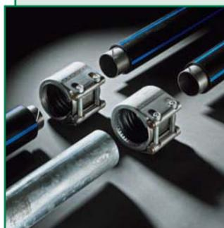
Муфты с жесткой осевой фиксацией для полимерных труб (ПЭ, ПП) и комбинированные для соединения полимерных труб с металлическими. Готовы к монтажу, свободно демонтируются и могут многократно использоваться при повторном монтаже. Поставляются в диапазоне диаметров от 40,0 до 250,0 мм (большие диаметры по запросу). Позволяют скомпенсировать угловое смещение
