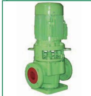
Электронасосы типа ЛМ – центробежные, консольные, моноблочные, линейные – предназначены для работы в стационарных условиях для перекачивания чистой воды производственно-технического назначения (кроме морской) с рН 6–9, температурой от 273 до 358 К (от 0 до +850 °С) и других жидкостей, сходных с чистой водой по плотности, вязкости и химической активности, содержащих твердые включения в количестве не более 0,1% по объему и размером частиц не более 0,2 мм.
