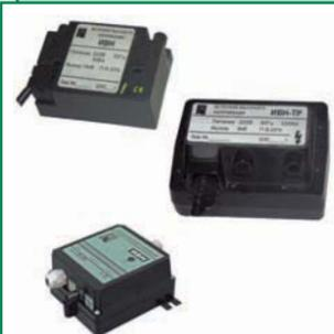
Источник высокого напряжения ИВН предназначен для искрового розжига газовых запальных горелок котельных агрегатов и служит для воспламенения топлива между электродом и корпусом установки. ИВН рекомендуется для применения на запально-защитных устройствах L < 1 000 мм. Модификация на питание – 24 В. Схема преобразования частоты с 50/60 Гц до 20 кГц.
