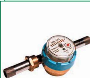
Счетчики СКВ применяются для учета и экономии потребления воды в индивидуальном секторе и системах коммунального и промышленного водоснабжения. Предназначены для измерения объема холодной воды при температуре не выше 40 °С и давлении не более 1МПа. Надежно работают при температуре окружающего воздуха от 5 до 50 °С и относительной влажности до 98%.
