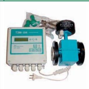
Электромагнитный теплосчетчик ТЭМ-104 представляет собой вычислительный блок и подключаемые к нему измерительные преобразователи расхода теплоносителя, преобразователи температуры теплоносителя и преобразователь избыточного давления в трубопроводе.
