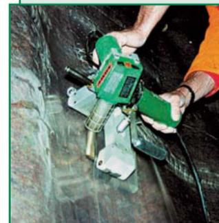
Прямая поставка аппаратов LEISTER (Швейцария) для сварки полимерных мембран из ПЭНД, ПЭВД, ПЭ-Х, ПВХ-П, ПП, ПФЭВЭ, ЭСБ, ЭВА, ТПО толщиной до 5 мм.
