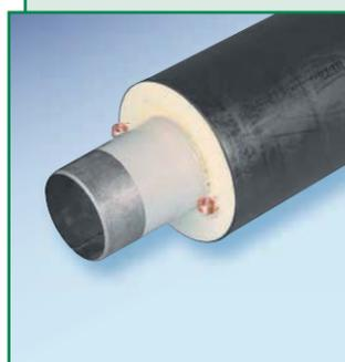
Трубы в ППУ изоляции применяются для бесканальной подземной и надземной прокладки тепловых сетей с температурой носителя до 150 °С. Стальные трубы в ППУ изоляции и гидрозащитной полиэтиленовой оболочке, стальные и полипропиленовые трубы в ППУ изоляции и гидрозащитной оболочке из полиэтилена или оцинкованной стали.
