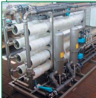
Мембранные обратноосмотические установки предназначены для глубокой или частичной очистки вод хозяйственно-бытового и питьевого назначения.
