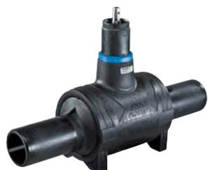
Запорная арматура FRIALOC® используется в водопроводных системах. Поставляется с мая 2008 г. Диаметр – от 90 до 180 мм. Срок службы корпуса – до 50 лет без обслуживания. Сверхстойкий к коррозии запорный механизм. Свободный переход к арматуре исключает сужение в месте соединения с трубой SDR 11. Сварной метод соединения позволяет создать единый узел трубы и арматуры.
