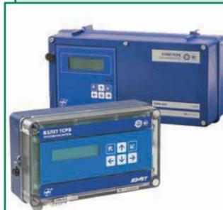
Теплосчетчики-регистраторы "ВЗЛЕТ ТСР-М" выпускаются в нескольких модификациях: ТСР-033 – для решения задач абонентского учета (энергонезависимый), ТСР-032 и ТСР-026 – для организации учета в ЖКХ, ТСР-024 – для организации учета на ЦТП и в многотрубных системах, ТСР-027 – для сложных условий эксплуатации.
