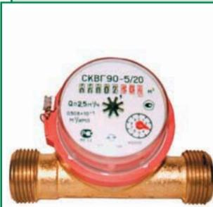
Счетчики СКВГ применяются для учета и экономии потребления воды в индивидуальном секторе и системах коммунального и промышленного водоснабжения. Предназначены для измерения объема горячей воды при температуре от 5 до 90 °С и давлении не более 1МПа. Надежно работают при температуре окружающего воздуха от 5 до 50 °С и относительной влажности до 98%.
