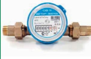
Счетчики предназначены для измерения объема холодной и горячей питьевой воды, протекающей по трубопроводу при температуре от +5 до +90 °С и давлении не более 1,0 МПа (10 кгс/см²). Возможна горизонтальная установка приборов (метрологический класс В) и вертикальная (наклонная) установка приборов (метрологический класс А). Диаметры условного прохода – 15; 20 мм.
