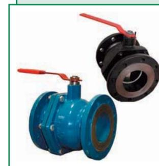
Шаровой кран фланцевый 11с 37 Пф-4 применяется в качестве запорного устройства на трубопроводах для воды и пара (температура рабочей среды до +200 °С, давление – 1,6–2,5 МПа); на объектах газового хозяйства (температура природного, топливного газа до +100 °С, давление – 1,6 МПа); для масла и нефтепродуктов (температура рабочей среды до +90 °С) и др. слабоагрессивных сред. Подача рабочей среды в любом направлении. Присоединение к трубопроводу – фланцевое.
