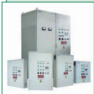
Автоматическая станция управления серии ИРЗ 600 предназначена для управления и защиты асинхронных электродвигателей привода насоса с целью поддержания заданного технологического параметра (давление, перепад давления, расход, температура) на объектах жилищно-коммунального хозяйства: системы холодного и горячего водоснабжения, отопления, канализации, кондиционирования, дымососов.
