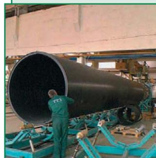
Трубы спиральновитые диаметром от 600 до 2 000 мм. Высокая жесткость (SN4, SN8), химическая стойкость. Глубина заложения – до 10 м. Применение: канализация, ливнестоки, дренаж, реновация трубопроводов.
