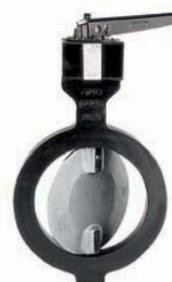
Затворы дисковые для регулирования газопотоков низкого давления ТУ 3741-025-29012225-2006. Серия ВА 99015. DN 40–1200 мм. PN 0,5 атм. Назначение – установка на трубопроводах в качестве регулирующих устройств. Служат для регулирования параметров газообразных рабочих сред посредством изменения ее расхода в соответствии с полученной командной информацией.
