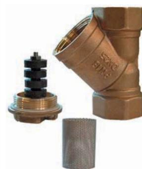
Магнитные фильтры "Туман" бытовой серии представляют собой модернизированный вариант муфтовых латунных фильтров для воды. Для улавливания частиц ржавчины и окислы из воды в корпусе стандартного фильтра устанавливается специальная магнитная система на основе мощных постоянных магнитов.
