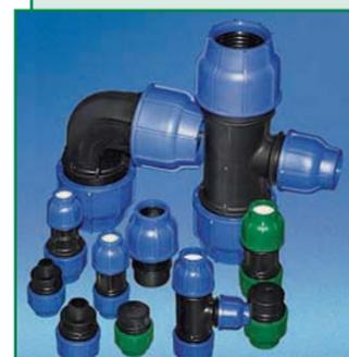
Компрессионные фитинги из полипропилена диаметром 25; 32; 40; 50; 63; 90; 110 мм с рабочим давлением 1,6 МПа (16 бар) для соединения водопроводных труб ПЭ 63, ПЭ 80 и ПЭ 100 без применения сварочных работ.
