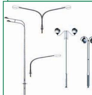
Опоры освещения высотой до 8 м.
