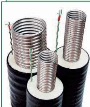
Гибкие трубы "КАСАФЛЕКС" предназначены для подземной бесканальной прокладки открытых и закрытых высокотемпературных сетей отопления с рабочей температурой до 160 °С (кратковременно – до 180 °С) и максимальным рабочим давлением 1,6 МПа.
