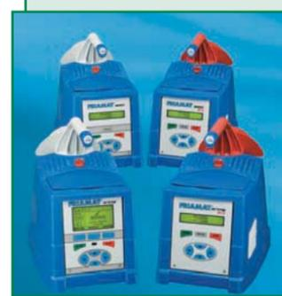
Аппараты серии FRIAMAT® применяются для газопроводов, водопроводов и канализации. Мощность – до 3,5 кВт. Сваривают муфты и фасонные изделия с закладными электронагревателями в диапазоне от 20 до 710 мм. Диапазон входных напряжений – от 180 до 270 В. Диапазон напряжений на выходе – от 8 до 50 В. В зависимости от типа аппарат может выполнять функцию протоколирования и обратного отслежи-
