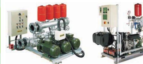
Комплектные насосные установки, подходящие также для систем пожаротушения, состоят из одного или нескольких насосов, объединенных гидравлической обвязкой с необходимой арматурой, подключенных к общему шкафу управления.
