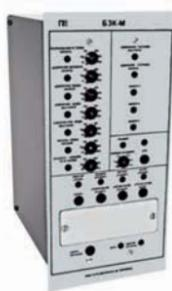
Блок защиты котла БЗК-м предназначен для работы с водогрейными и паровыми котлами для индикации их состояния по 12 параметрам, выдачи звукового сигнала и отключения подачи топлива в аварийных ситуациях.
