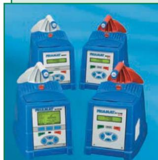
Аппараты серии FRIAMAT® применяются для газопроводов, водопроводов и канализации. Мощность – до 3,5 кВт. Сваривают муфты и фасонные изделия с закладными электронагревателями в диапазоне от 20 до 710 мм. Диапазон входных напряжений – от 180 до 270 В. Диапазон напряжений на выходе – от 8 до 50 В. В зависимости от типа аппарат может выполнять функцию протоколирования и обратного отслежи-
