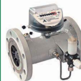
Счетчики газа СГ-16МТ, СГ-75МТ, СГ-16МТ-Р, СГ-75МТ-Р предназначены для измерения объема плавно меняющихся потоков очищенных неагрессивных одно- и многокомпонентных газов (природный газ, воздух, азот, аргон и др.) с плотностью при нормальных условиях не менее 0,67 кг/м<sup>3</sup>.
