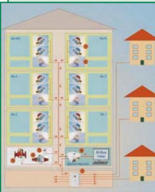
Проводная система M-Bus.
