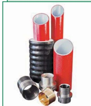
Запатентованные гибкие трубы повышенной надежности «ИЗОПРОФЛЕКС®-А» предназначены для подземной бесканальной прокладки сетей горячего водоснабжения и отопления с рабочей температурой до 95 °С (кратковременно – до 110 °С) и максимальным рабочим давлением 1,0 МПа.
