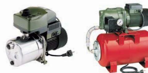
Автоматические насосные станции характеризуются применением самовсасывающих центробежных насосов, которые могут работать даже в случае присутствия в перекачиваемой воде небольшого количества песка. Автоматически поддерживают заданное давление в системе водоснабжения. Широко применяются для подачи воды из колодцев и скважин.
