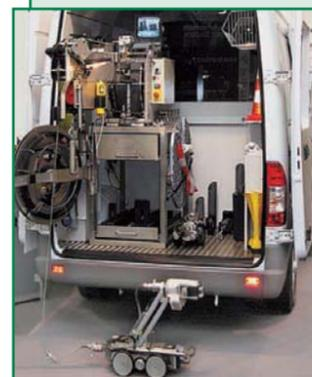
Оборудование для теледиагностики трубопроводов RICO (Германия) позволяет исследовать проталкиваемыми камерами, роботами и телеинспекционными системами, встроенными в автомобиль, каналы диаметром от 25 до 2 000 мм, длиной до 1 000 м.
