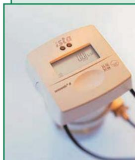
Компактный теплосчетчик "Сенсоник II" – это вычислитель, многоструйный расходомер и датчик температуры в одном корпусе. Применяется для учета тепла в квартирах, офисах, коттеджах.
