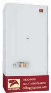
Современный настенный газовый котел “ЛЕМАКС” предназначен для отопления жилых помещений и горячего водоснабжения, идеален для квартир и других помещений. Максимальная мощность – 24 кВт. КПД – 93%. Варианты с искусственной и естественной тягой. Битермический теплообменник. Циркуляционный насос Grundfos (Дания).
