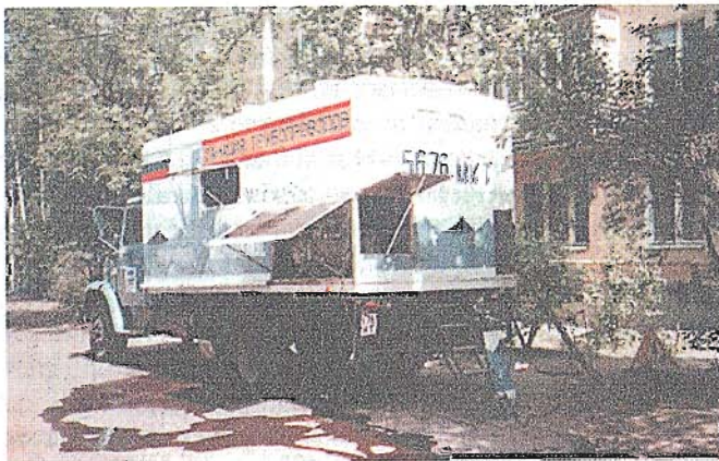
Рис. 3.33. Автомобиль с необходимым для телеинспекции оборудованием
