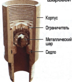
Клапан обратный шаровой
