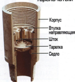
Клапан обратный тарельчатый
