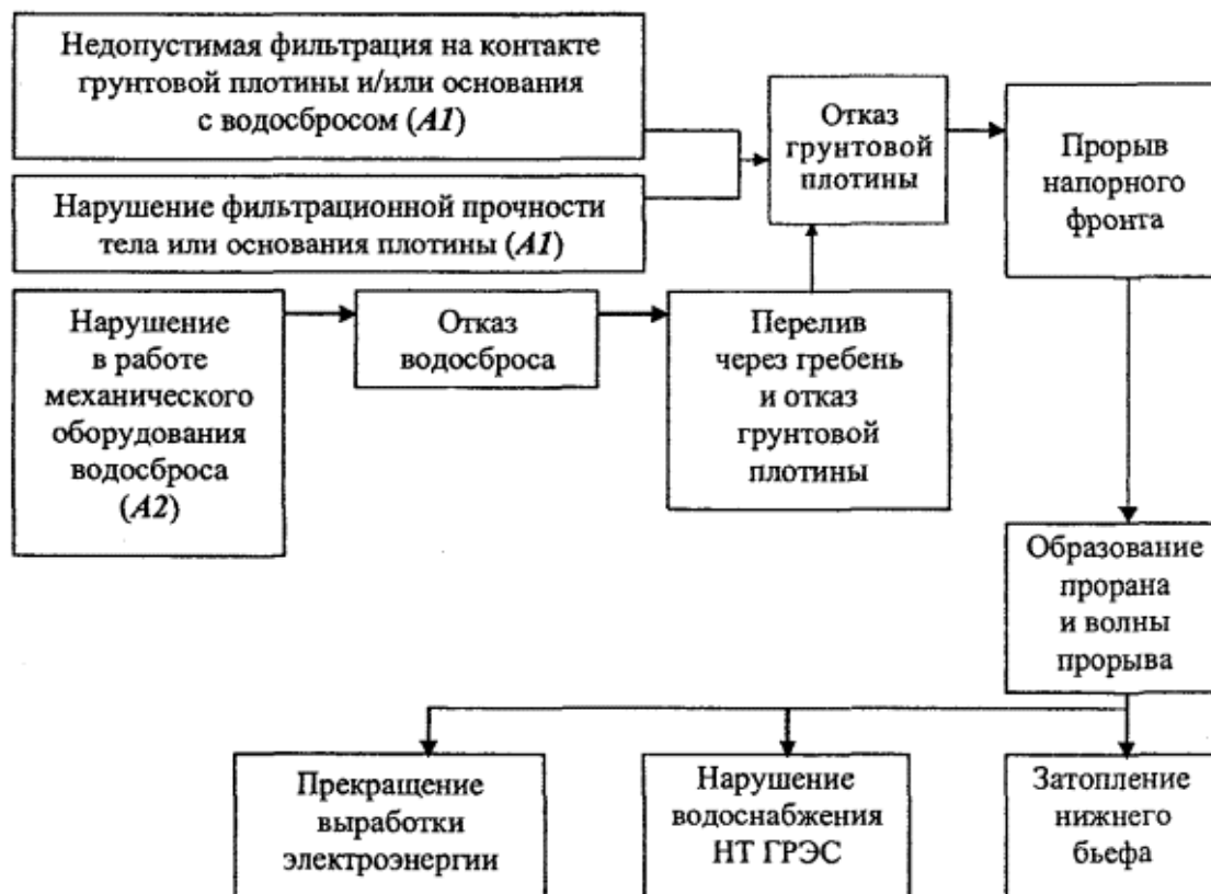
Рис. П.2.7. Блок-схема развития аварийного процесса для сценариев А1 пА2
