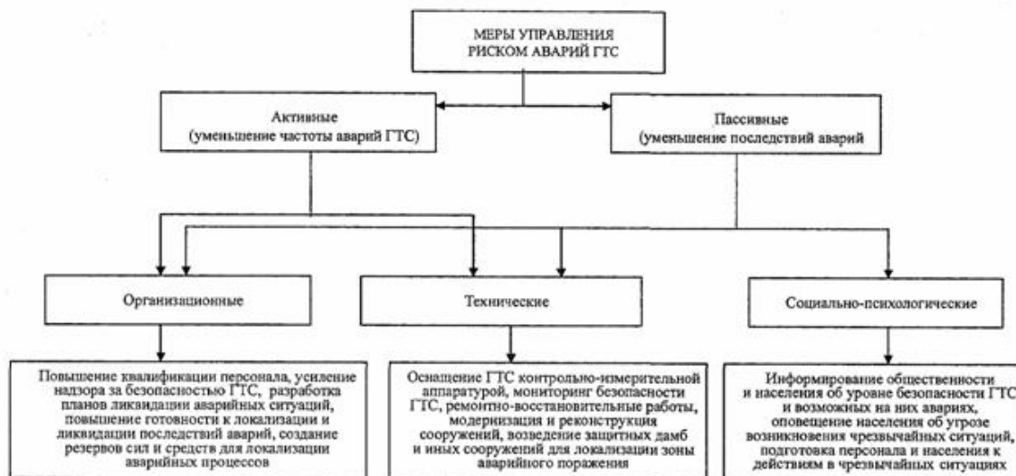
Рис. 5. Возможные меры управления риском аварий гидротехнических сооружений
