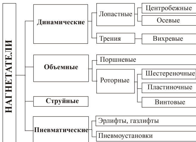
Рис. 1.1. Классификация нагнетателей по принципу действия
