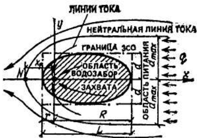
Рис. 36. Схема фильтрации подземных вод в сторону водозабора
