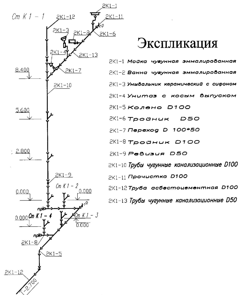
Рис. 31. Аксонометрическая схема внутренней канализации
