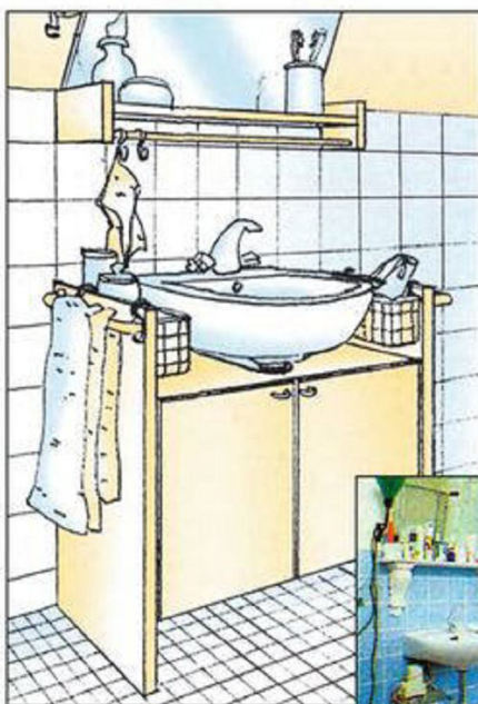
Рис. 9. Самодельная тумба укрывает проточный водонагреватель и сливную арматуру. Снаружи к боковым стенкам тумбы можно прикрепить ещё и полотенцедержатели.
