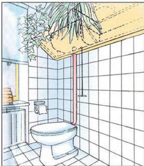
Рис. 3. Здесь показано, как можно укрыть смывной бачок наклонно установленным экраном с вырезами для труб и цепочки.
