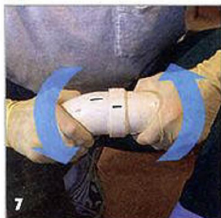
Сборка трубопровода. Соедините и поверните детали, пока не совпадут ориентирующие отметки.
