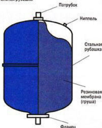
Рис. 2. Гидроаккумулятор после заполнения водой.
