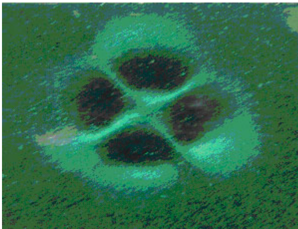
Рис. 5. Топология магнитных полей 4-х и 2-х полюсных кольцевых магнитов (соответственно слева и справа) в магнитных полумуфтах счётчиков воды.
