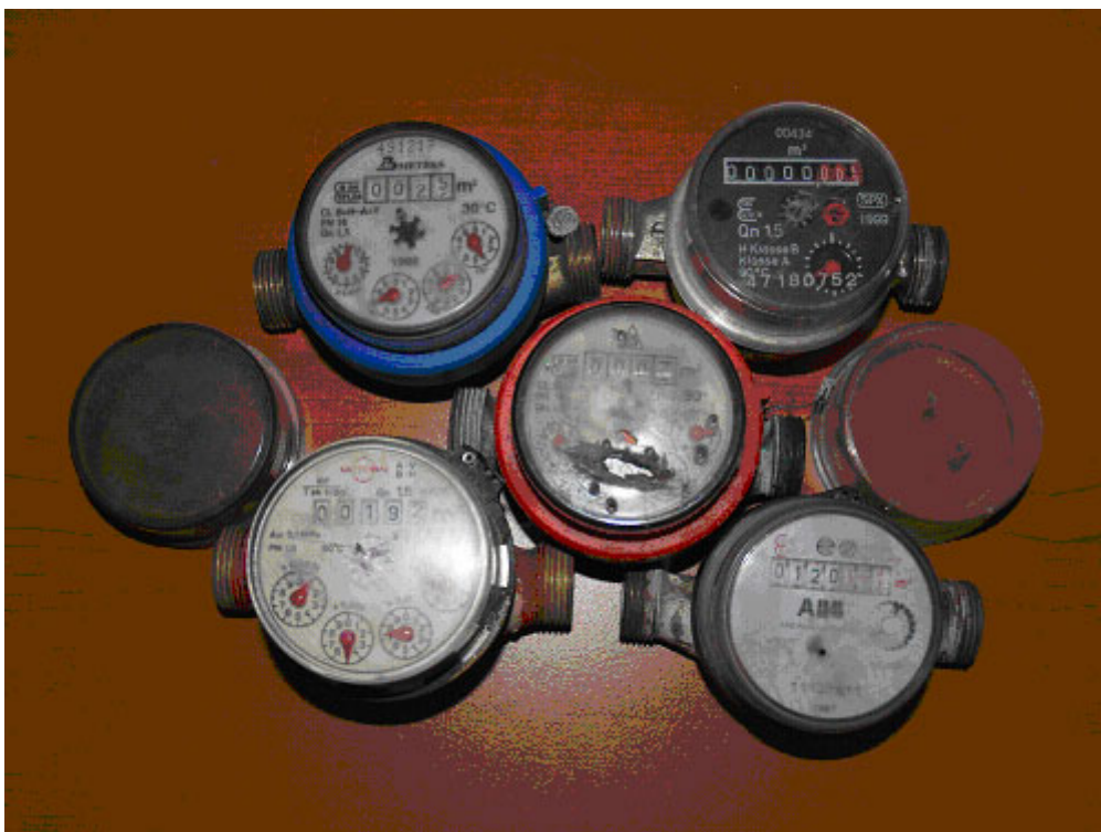
Рис.1. Несанкционированные воздействия через пластмассовый колпак счетчика.
