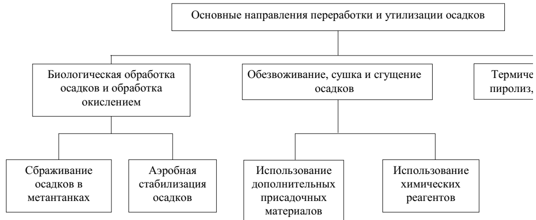
Рис. 4. Очистка осадков сточных вод
