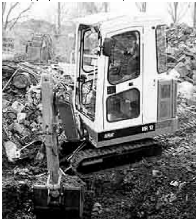
Рисунок 2. Гусеничный мини-экскаватор модели HR12 фирмы "Karl Schaeff GmbH & Co".
