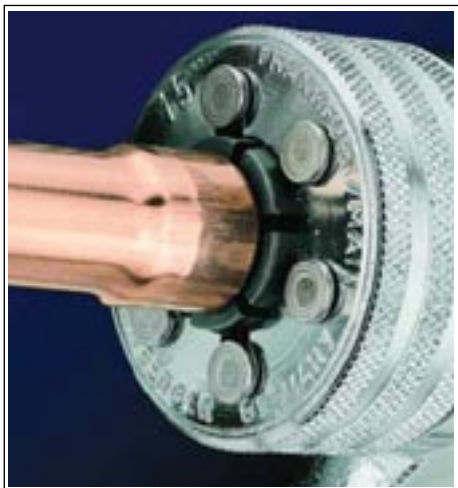
Fig. 21 Executarea unei mufe folosind un expandor: Este necesar ca mufa să fie executată în așa fel, ca expandorul să țină adâncimea prescrisă a inserției în țevă, adică expandorul trebuie inserat în țevă până la refuz înainte și în timpul executării.
