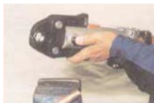
f) Se pune falca de presare pe insertie și se fixează cuiul de fixare.
