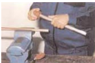
b) Se debavurează muchii interioare și exterioare de pe țeavă (calibrarea).
