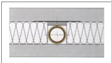
Fig. 38 Țeavă pozată corect.
