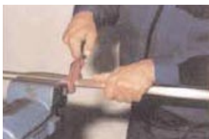
a) Se taie țeava - cu un cutter sau ferăstrău fin.
