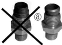
5. До упора вдвинуть импульсную трубку (9) в резьбовое соединение.
