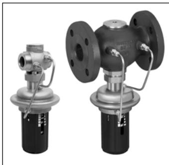
**AVPA** представляет собой автоматический регулятор для сброса избыточного перепада давления, предназначенный для систем централизованного теплоснабжения. Регулятор состоит из регулирующего клапана, привода с регулирующей диафрагмой (регулирующего элемента) **AVPA** и рукояткой для настройки перепада давления. Регулятор нормально закрыт и открывается при возрастании перепада давления.
