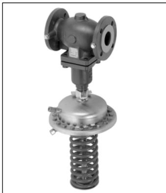
**AFD** является автоматическим редуцирующим клапаном, поддерживающим постоянное давление в трубопроводе после регулятора (по ходу движения теплоносителя). Регулятор предназначен для применения в системах централизованного теплоснабжения. При повышении давления после регулятора – клапан закрывается. Регулятор состоит из регулирующего фланцевого клапана **VFG 2(21)** или **VFGS 2**, регулирующего элемента **AFD** с диафрагмой и пружиной для настройки давления, импульсной трубки типа **AF**.
