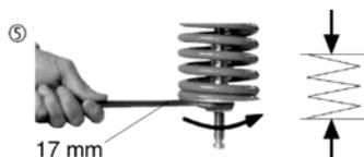
Вращение гайки против часовой стрелки (6) снижает значение давления (ослабляет пружину).
