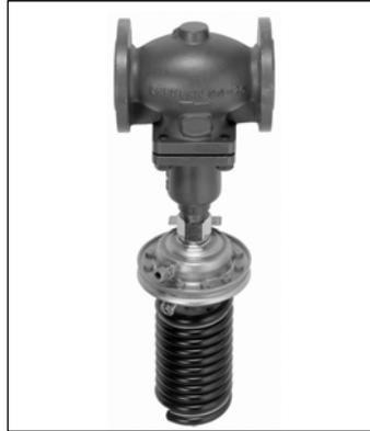
**AFA** является автоматическим регулятором, поддерживающим постоянное давление в трубопроводе до регулятора (по ходу движения теплоносителя). Предназначен для применения в системах централизованного теплоснабжения. При повышении давления до регулятора клапан открывается. Регулятор состоит из регулирующего фланцевого клапана **VFG 2(21)**, регулирующего элемента **AFA** с диафрагмой и пружиной для настройки давления, импульсной трубки типа **AF**.
