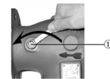
3. Завернуть штуцер (2) в резьбовые отверстия G 1/4, используя медные уплотнительные шайбы (3), крутящим моментом 40 Нм.
