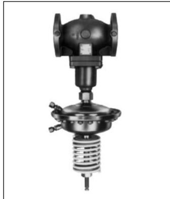
**AFPA** представляет собой автоматический регулятор перепада давления, предназначенный для систем централизованного теплоснабжения. Регулятор состоит из регулирующего фланцевого клапана **VFG 2(21)**, регулирующего элемента (привода) **AFPA** с диафрагмой и пружиной для настройки перепада давления, импульсных трубок типа **AF**. При повышении перепада давления на регуляторе его клапан открывается.
