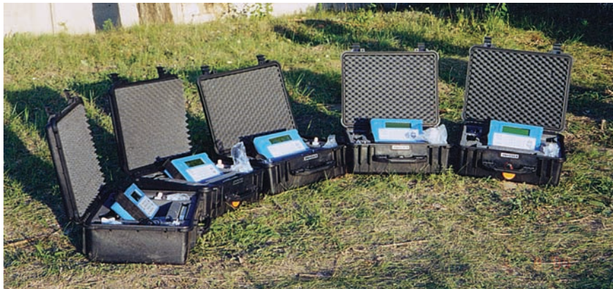
Рис. 2.1. Ультразвуковые накладные расходомеры UFM 610 р
