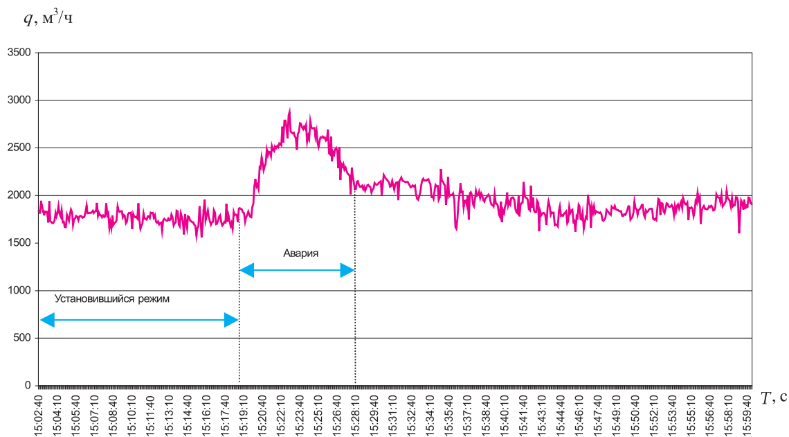
Рис. 5.27. Изменение водопотребления Алексеевского жилого массива от насосной станции № 25А с 15:00:00 до 16:00:00 ч 16.02.2001 г.
