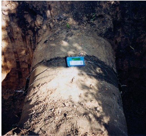
Рис. 2.4. Измерение скорости и расхода воды в водоводе диаметром 1600 мм
