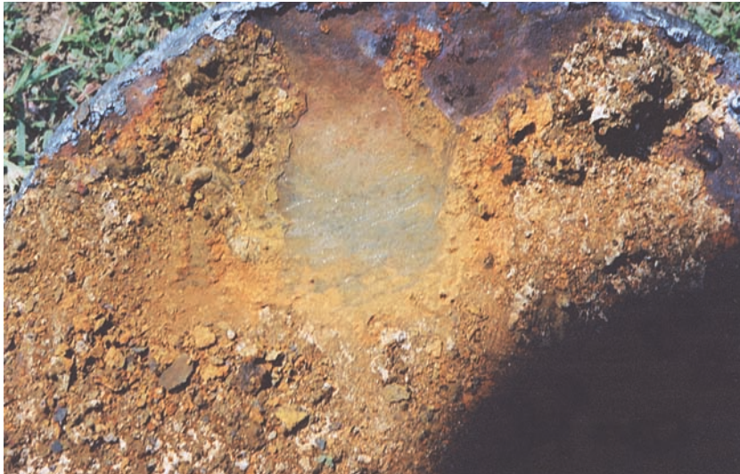
Рис. 3.10. Пальпация макрошероховатости с анаэробными бактериями
