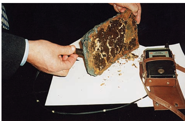
Рис. 2.8. Измерение с помощью толщиномера УТ-93 П толщины инкрустированного образца, взятого с водовода диаметром 1400 мм
