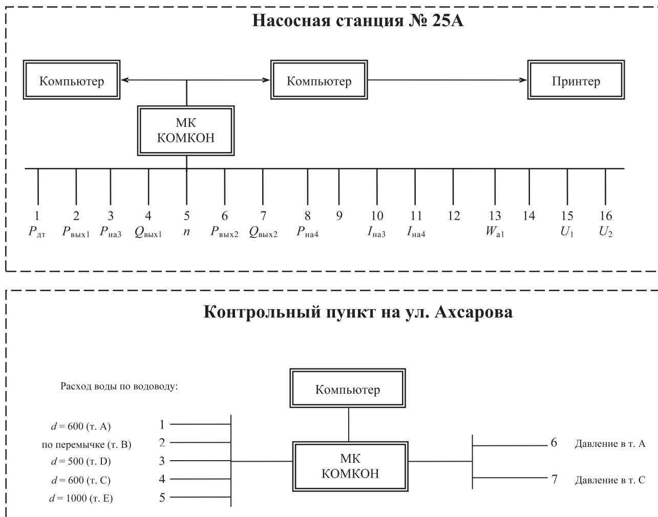
Рис. 2.12. Блок-схема системы измерений
