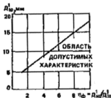
Рис. 129. График для подбора первого слоя фильтра в супесчаных грунтах (с числом пластичности w_n = 3 - 6 ) при любой схеме движения воды
