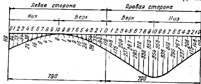
Рис. 55. Развертка конца люка резервуара.
