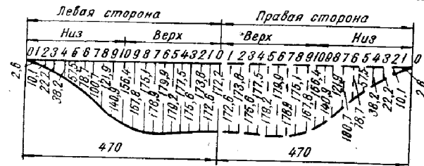
Рис. 62. Развертка конца отрезка сварного тройника.
