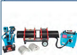
Предназначен для стыковой сварки напорных трубопроводов Ø 75–250 мм (до PN 32), в т. ч. газопроводов, из полипропилена, полиэтилена и других термопластиков.
