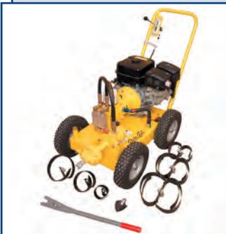
Секционная машина «модель 325» производства компании Electric Eel (США) предназначена для пробивки сложных засоров в трубах. Разработана для компаний, специализирующихся на устранении засоров в канализации, – водоканалов, аварийных служб и т. д.
