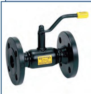
Запорные шаровые краны БРОЕН серии Балломакс (Ballomax) различного исполнения. Области применения: теплоснабжение, холодоснабжение, газоснабжение, транспортировка нефтепродуктов и др. DN 15–1000. PN 16; 25; 40; 63; 100. Варианты исполнения: полнопроходные, полупроходные, краны шаровые под задвижку (КШЗ), с удлиненным штоком и др.
