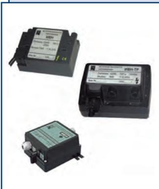
Источник высокого напряжения ИВН предназначен для искрового розжига газовых запальных горелок котельных агрегатов и служит для воспламенения топлива между электродом и корпусом установки. Рекомендуется для применения на запально-защитных устройствах  $L < 1000$  мм. Модификация на питание – 24 В. Схема преобразования частоты с 50/60 Гц до 20 кГц.
