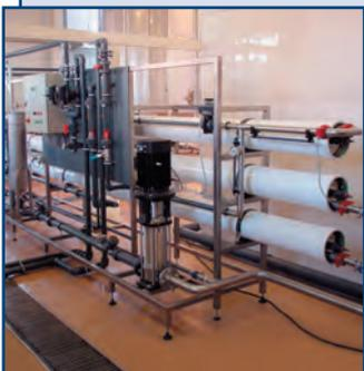
Системы обратного осмоса, нано- и ультрафильтрации.
