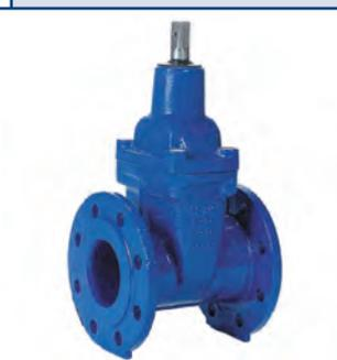
Клиновые задвижки с обрешиненным клином, закрепленной болтами крышкой, вращающимся штоком с внутренней резьбой. Фланцевые соединения по стандарту EN. Строительная длина по стандартам EN 558/14 и EN 558/15. Корпус из чугуна с шаровидным графитом.
