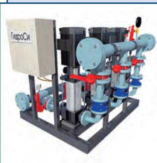
Насосные установки ГидроСи предназначены для повышения и поддержания давления в системах холодного, горячего водоснабжения, а также для пожаротушения и др. Выпускаются в полной заводской готовности различного исполнения и комплектации: с рабочими и резервными насосами, смонтированными на единой раме-основании, обвязанными запорной арматурой, со щитом управления и контрольно-измерительными приборами.
