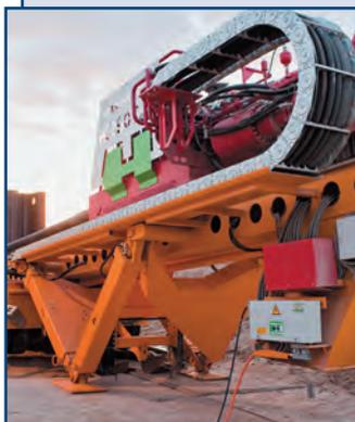
Установки горизонтального направленного бурения (ГНБ) производства компании Herrenknecht AG (Германия) с тяговым усилием до 600 тн предназначены для строительства трубопроводов различного назначения.
