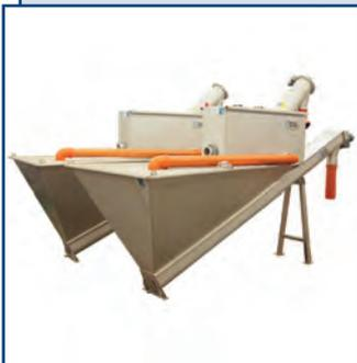
Блок механической очистки сточных вод (решетка + песколовка) предназначен для выделения твердых частиц из хозяйственно-бытовых сточных вод.
