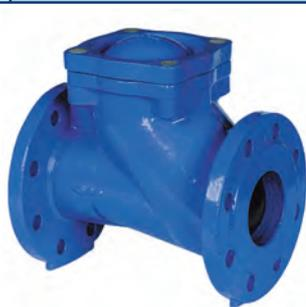
Обратные клапаны из чугуна или ковкого чугуна, с фланцами или резьбовыми патрубками F/F. Фланцевые соединения по стандарту EN, резьбовые соединения по ISO 7/1. Строительная длина по EN 558/48. Шаровой наконечник с покрытием NBR, с закрепленной болтами крышкой. Для горизонтальной и вертикальной установки.
