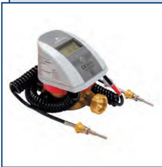
Компактный теплосчетчик ELF представляет собой электронный вычислитель и 2 датчика температуры Pt-500, выполненные в едином корпусе с тахометрическим счетчиком расхода.
