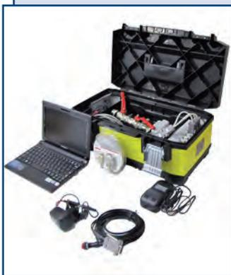
Поверочные переносные установки «Каскад-2П» предназначены для проведения периодических и внеочередных поверок и регулировок счетчиков горячей и холодной воды непосредственно на месте их эксплуатации без демонтажа с трубопровода.
