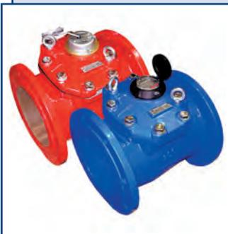
Счетчики воды ВСХН, ВСХНд, ВСГН, ВСТН – турбинные, сухоходные. Предназначены для измерения объема сетевой и питьевой воды, протекающей в обратном или подающем трубопроводе закрытых и открытых систем теплоснабжения, системах холодного и горячего водоснабжения.
