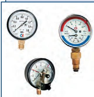
Манометры, термоманометры, мановакууметры предназначены для измерения давления неагрессивных к медным сплавам, жидких и газообразных, вязких и некристаллизирующихся сред с температурой до 150 °С.
