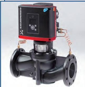
Области применения: отопление, кондиционирование, вентиляция, повышение давления. Широкий выбор параметров и исполнений для различных условий эксплуатации. Подача – до 4500 м<sup>3</sup>/ч (серии TPE-TPED – до 544 м<sup>3</sup>/ч). Напор – до 168 м (серии TPE-TPED – до 98 м). Температура перекачиваемой жидкости – от -25 до +140 °С. Максимальное рабочее давление – 10/16/25 бар.
