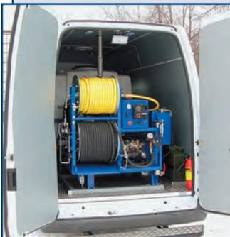
Компактные каналопромывочные машины VHT (Ван Хаут Текнолоджиз):
