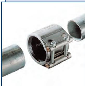
Соединительные муфты Straub (Ø 26–4064 мм) предназначены для монтажа трубопроводов из любых материалов (сталь, чугун, цемент, ПВХ, ПЭ) для различной среды (газ, вода, сточные воды, масла, горюче-смазочные вещества, химические продукты).
