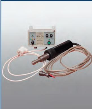
Ультразвуковой противонакипной аппарат УПА-2М предназначен удаления накипи посредством разрушения ее механическими колебаниями ультразвуковой частоты, передаваемыми на стенки теплоагрегата.
