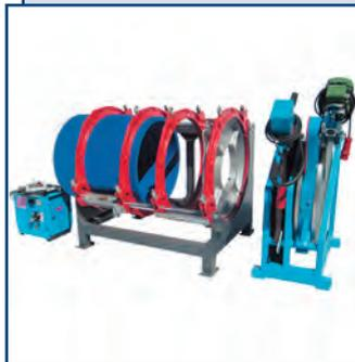
Предназначен для стыковой сварки напорных трубопроводов Ø 500–800 мм (до PN 32), в т. ч. газопроводов, из полипропилена, полиэтилена и других термопластиков.
