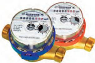
Крыльчатые, одноструйные, сухходные счетчики воды ВСГ, ВСГд, ВСХ, ВСХд, ВСТ предназначены для измерения объема холодной и горячей воды в системах горячего, холодного водоснабжения, а также в системах отопления.
