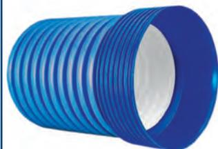
Трубы гофрированные двухслойные ТЕХСТРОЙ для подземных безнапорных трубопроводов. Выпускаются согласно ТУ 2248-011-54432486-2013 из полиэтилена (ПЭ) и полипропилена (ПП) с классом жесткости SN4 (ПЭ), SN6 (ПЭ), SN8 (ПП), SN12 (ПП). Диаметр – от 110 до 1000 мм.
