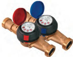
Крыльчатые, одноструйные, сухходные счетчики воды ВСХ, ВСХд, ВСГ, ВСГд, ВСТ предназначены для измерения объема сетевой и питьевой воды, протекающей в обратном или подающем трубопроводе закрытых и открытых систем теплоснабжения, системах холодного и горячего водоснабжения.
