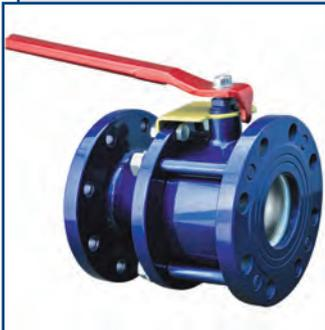
Разборная конструкция корпуса позволяет осуществлять ремонт и горячую замену основных деталей (уплотнений, шара и др.), тарельчатая пружина компенсирует износ уплотнительных элементов.
