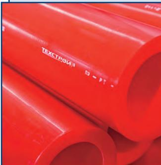
Трубы для горячего водоснабжения из полиэтилена повышенной термостойкости PE-RT соответствуют ТУ 2248-012-54432486-2013. Диаметр – от 20 до 630 мм, SDR 21–7,4.
