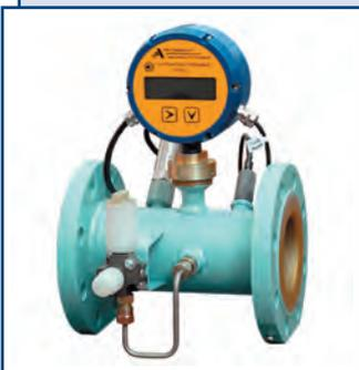
Счетчики газа турбинные СГТ16Э предназначены для измерения объема неагрессивного неоднородного по химическому составу природного газа, воздуха, азота и других неагрессивных газов с плотностью не менее 0,67 кг/м<sup>3</sup> с функцией пересчета измеренного объема к нормальным условиям по давлению и температуре. С учетом коэффициентов сжимаемости и химического состава газа имеется вариант исполнения без функций приведения к нормальным условиям.
