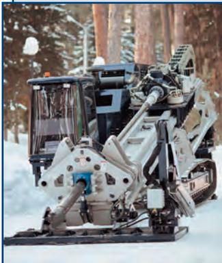
Предназначены для бестраншейного строительства подземных коммуникаций в следующих отраслях: энергетика, водоснабжение и водоотведение, газоснабжение, телекоммуникация и связь, строительство магистральных нефте-, газо-, продуктопроводов.
