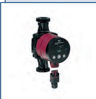
Области применения: циркуляция воды и гликолевой жидкости в бытовых системах отопления; циркуляция в системах ГВС (исполнение N). Подача – до 3 м<sup>3</sup>/ч. Напор – до 6 м. Температура перекачиваемой жидкости – от +2 до +110 °С. Максимальное давление – 10 бар. Основные преимущества:
