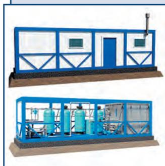
Предназначены для очистки воды из подземного (артезианского) или поверхностного природного источника до требований норм СанПиН 2.1.4.1074-01.
