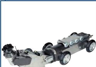
Разработка, проектирование и производство роботов для ремонта трубопроводов. Робототехнические комплексы IMS предназначены для фрезерно-подрезных и шлифовальных работ в трубопроводах, например для обработки свищей, трещин с целью их последующей заделки. Используются перед санацией трубопровода с применением полиэтиленового рукава для зачистки grата на сварном шве и обрезки выступающих острых частей в трубах. Устраняют дефекты некачественных работ по проведению ЦПП или санации.
