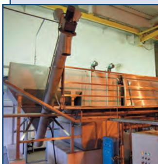
Предназначена для очистки ливневых сточных вод, стоков химического, мясного, рыбного, молочного, кондитерского производств, снижает показатели БПК, ХПК, взвешенных веществ, жиров, фосфатов. Производительность – от 20 до 120 м³/ч. Совмещенный вариант горизонтального флотатора с песколовкой. Включает донный шнек для удаления оседающих частиц.
