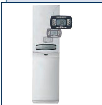
Настенный газовый котел LUNA-3 Comfort COMBI – единый напольный отопительный блок, состоящий из одноконтурного котла и накопительного бойлера из нержавеющей стали емкостью 80 л. Нагрев 520 л воды в течение 30 мин при  $\Delta t = 30^\circ\text{C}$ . Специальная конструкция бойлера и входящие в комплект декоративные панели позволяют устанавливать котел на бойлер без дополнительного крепления к стене. Компактные габаритные размеры – 1640 × 450 × 550 мм.
