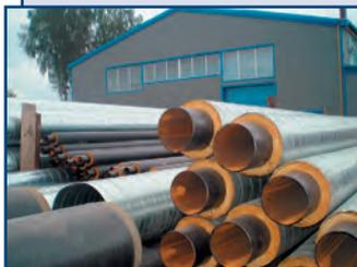
Трубы ППУ представляют собой трехслойную, монолитную конструкцию, состоящую из стальной трубы, теплоизолирующего слоя пенополиуретана и защитной оболочки из полиэтилена для подземной прокладки или оцинкованной спирально-замковой стали для воздушной прокладки.
