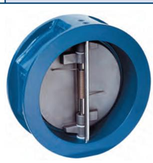
Обратный затвор с двойной створкой SERIE 2000 используется в системах отопления, кондиционирования, водоснабжения, орошения, водоподготовки. Цельный корпус из чугуна. Уплотнение – металл/эластомер или металл/металл. Не требует технического обслуживания.
