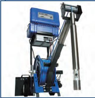
Телеинспекционное оборудование контроля скважин производства Laval Underground Surveys (США).
