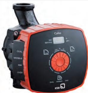
Высокоэффективный насос с мокрым ротором применяется в системах отопления, горячего водоснабжения, холодоснабжения, вентиляции и кондиционирования зданий и сооружений. Диапазон рабочих температур – от -10 до +110 °С. Напор – до 10 м. Расход – до 13 м<sup>3</sup>/ч.
