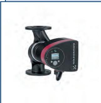
Области применения: циркуляция воды в системах отопления, горячего водоснабжения, охлаждения и кондиционирования. Подача – до 70 м<sup>3</sup>/ч (для сдвоенных – до 140 м<sup>3</sup>/ч). Напор – до 18 м. Температура перекачиваемой жидкости – от -10 до +110 °С.
