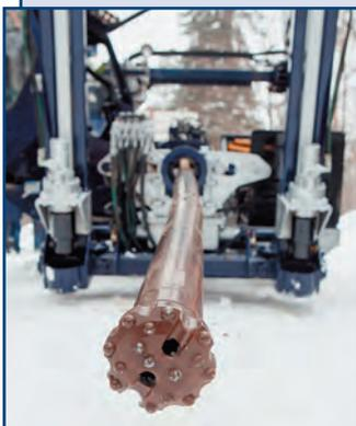
Пневмомолот UNIHAMMER производства компании UNIVERSAL HDD (США) – уникальный инструмент на базе установки горизонтального направленного бурения (ГНБ), созданный для бестраншейного строительства трубопроводов в сложных горно-геологических условиях.
