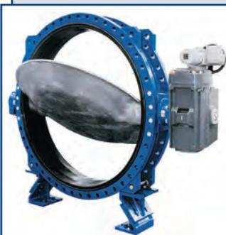
Центрический дисковый затвор с кольцевой вставкой из эластомера. Применяется с понижающим редуктором, электрическим, гидравлическим приводом и приводом с грузовым возвратом. U-образный корпус / корпус с двойными фланцами без выступающей кромки. Соединения по EN, ASME, JIS.
