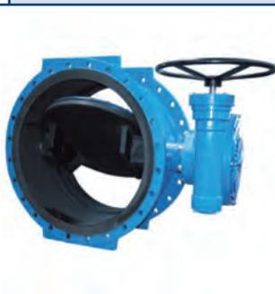
Дисковый поворотный затвор с двойным смещением диска, уплотнение с эпоксидным или эластомерным покрытием (вулканизированный). Перекрытие потока в любом направлении. Фланцевые соединения по стандарту EN. Строительная длина по EN 558/14. Корпус и диск из чугуна с шаровидным графитом.
