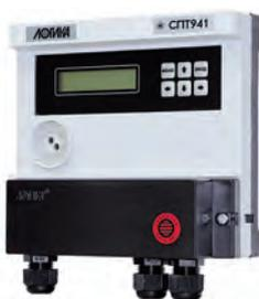
С автономным питанием. Для закрытых и открытых водяных систем. Обслуживает три трубопровода. Для работы с расходомерами, имеющими импульсный выходной сигнал. Имеет простой и удобный интерфейс пользователя, наглядные процедуры просмотра архивов. Поддерживает работу с телефонными и GSM-модемами. Комплектуется фирменным ПО для дистанционного считывания данных и интегрирования в автоматизированные системы. Используется в составе теплосчетчиков ЛОГИКА 8941, ЛОГИКА 1941.
