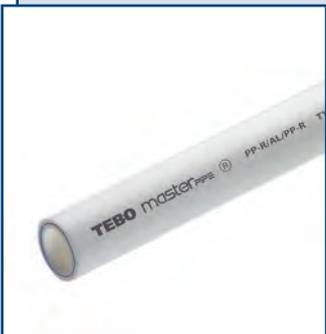
Трубы TEBO Masterpipe® изготовлены из полипропилена, армированного перфорированной алюминиевой фольгой. Предназначены для монтажа систем холодного, горячего водоснабжения и отопления. Диаметр – от 20 до 110 мм.
