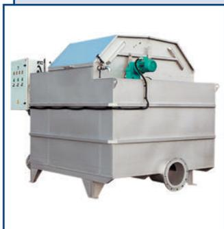
Дисковые фильтры позволяют дополнительно очищать стоки от взвешенных веществ и БПК перед подачей на обеззараживание или на сброс. Надежная конструкция (нержавеющая сталь, высокопрочная пластмасса, качественная полиэстеровая ткань) низкое энергопотребление. Промывка фильтров осуществляется в автоматическом режиме отфильтрованной сточной водой. Производительность – до 500 л/с.
