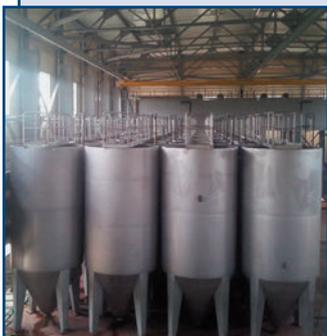
Фильтры предназначены для очистки воды поверхностных водоисточников, скважин, сточных вод. Работа основана на принципе фильтрования через зернистую загрузку.
