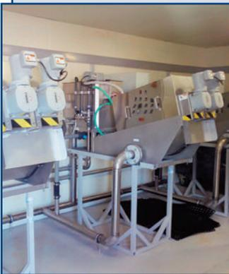
Модуль обработки осадка (МОО) собственного производства выполнен в виде одного или нескольких стандартных контейнеров, внутри которых смонтировано необходимое оборудование.
