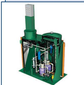
Блок предназначен для обеззараживания очищенных сточных вод до норм сброса непосредственно на грунт или в водоем. Выполнен из полипропилена. В состав блока входят: безнапорный фильтр, рабочий и резервный насосы, напорный сорбционный фильтр с шестиходовым вентилем переключения режимов, УФ-лампа, аварийный насос, блок управления и автоматики. Производительность – 1–30 м<sup>3</sup>/час.
