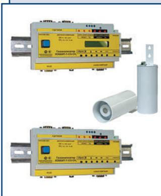
Стационарный прибор типа «Хоббит-Т-СО-СН4» обеспечивает контроль окиси углерода в соответствии с Инструкцией по контролю за содержанием окиси углерода в помещениях котельных РД 12-341-00. При использовании газового топлива обеспечивает контроль утечки метана и других взрывоопасных газов. Применяется в котельных любого типа.
