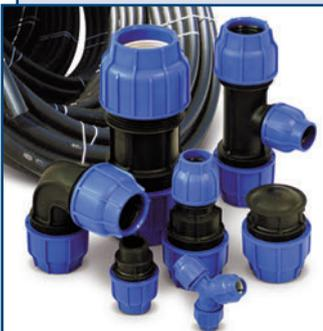
Компрессионные фитинги из PP для соединения водопроводных труб PE 63, PE 80 и PE 100 без применения сварочных работ.
