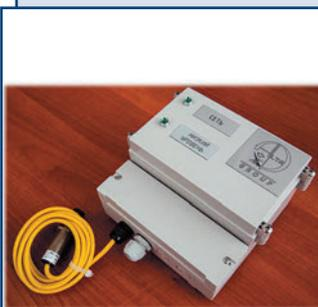
Емкостные датчики применяются для контроля и определения уровня жира, жидкости и сыпучих материалов в емкостях и резервуарах. В комплекте с устройствами анализа и вывода информации образуют надежную систему контроля уровня и управления технологическим оборудованием.
