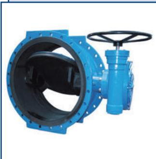
Дисковый поворотный затвор с двойным смещением диска, уплотнение с эпоксидным или эластомерным покрытием (вулканизированный). Перекрытие потока в любом направлении. Фланцевые соединения по стандарту EN. Строительная длина по EN 558/14. Корпус и диск из чугуна с шаровидным графитом.
