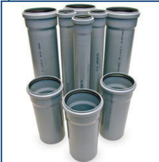
Широкий ассортимент труб из полипропилена для внутренней канализации номинальным диаметром 32, 50, 75, 90, 110, 125 и 160 мм. Применяются для отвода стоков во внутридомовой системе канализации. Укомплектованы двухлепестковыми уплотнительными кольцами от немецкого производителя M.O.L.
