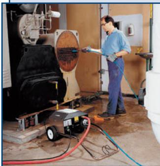
Очистители труб, котлов и теплообменных аппаратов General Industrial – это механические устройства с пневмо- или электроприводом, сверлами, щетками и специальными приспособлениями для очистки любых труб (в т. ч. и U-образных).
