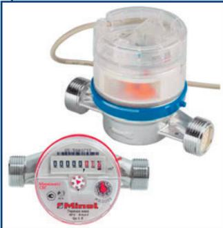
Крыльчатые одноструйные сухходные счетчики воды ЕТК/ЕТW, ЕТК-І/ЕТW-І, СВХ/СВГ Миномесс, СВХІ/СВГІ Миномесс с рабочим диапазонами 40, 90 и 150 °С представлены как в обычном исполнении, так и с импульсным выходом для возможности диспетчеризации и построения системы АСКУЭ.
