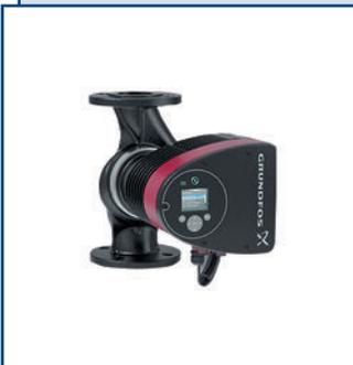
Области применения: циркуляция воды в системах отопления, горячего водоснабжения, охлаждения и кондиционирования. Подача – до 70 м<sup>3</sup>/ч (для сдвоенных – до 140 м<sup>3</sup>/ч). Напор – до 18 м. Температура перекачиваемой жидкости – от -10 до +110 °С.
