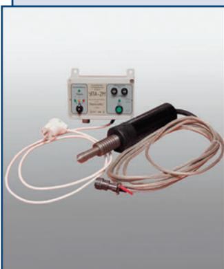
Ультразвуковой противонакипной аппарат УПА-2М предназначен для удаления накипи посредством разрушения ее механическими колебаниями ультразвуковой частоты, передаваемыми на стенки теплоагрегата.
