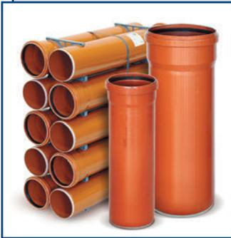
Трубы из полипропилена для наружной канализации диаметром 75; 110; 160; 250 мм. Морозостойчивость и ударпрочность благодаря трехслойной структуре и специальным наполнителям. Высокая степень звукоизоляции. Конструкция раструба обеспечивает легкий монтаж труб. Уплотнительное кольцо выполнено из эластомера по европейской технологии и обеспечивает надежное соединение труб и отсутствие протечек.
