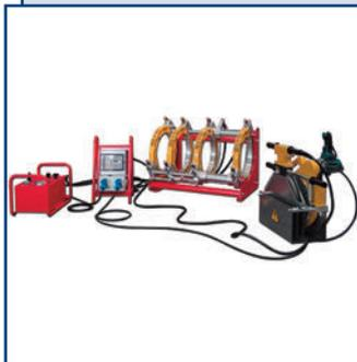
Широкий спектр машин для сварки полимерных трубопроводов диаметром от 16 до 1400 мм производства O.M.I.S.A.
