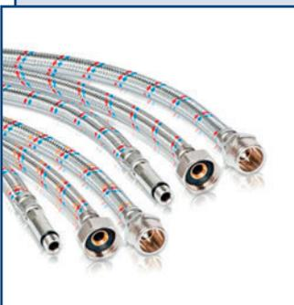
Гибкая подводка Altstream Super (на основе PE-X) предназначена для подключения оборудования к системам горячего и холодного водоснабжения. Отличительная особенность – высокая устойчивость к внешним физическим нагрузкам, высоким температурам (до 100 °С) и давлению (до 20 атм).
