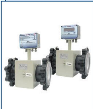
Расходомеры-счетчики ВСЭ (Россия) предназначены для измерения объемного расхода воды в системах водо- и теплоснабжения в напорных наполненных трубопроводах. Могут использоваться как в составе теплосчетчика, так и отдельно. Для передачи данных о расходе и объеме имеется импульсный выход и цифровой интерфейс RS485. Могут интегрироваться в системы диспетчеризации.
