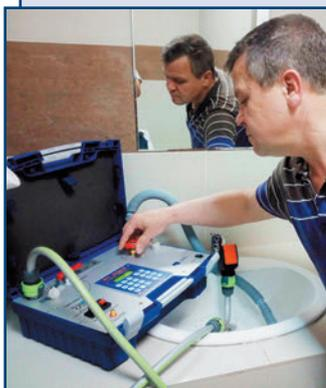
Установки поверочные ВПУ-Энерго М предназначены для поверки счетчиков воды на месте эксплуатации без демонтажа. Тип установки утвержден Росстандартом России. Регистрационный номер 60661-15.
