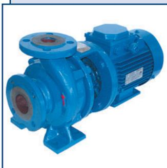
Предназначены для перекачивания чистой воды (кроме морской) с температурой от 0 до +120 °С, рН от 6 до 9, а также других жидкостей, сходных с водой по плотности, вязкости и химической активности.
