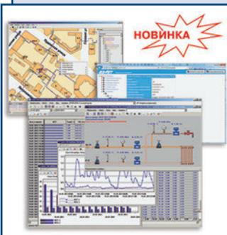
Обеспечивает обработку измерительной информации, источником которой является комплекс ВЗЛЕТ СП, и расширяет возможности комплекса ВЗЛЕТ СП в части анализа и визуализации измерительной, диагностической, нормативно-справочной информации с приоритетом на решение задач диспетчерского контроля параметров энергоснабжения/энергопотребления и состояния приборов учета.
