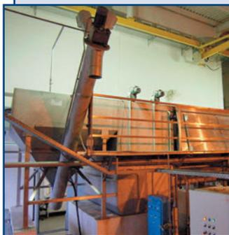
Предназначена для очистки ливневых сточных вод, стоков химического, мясного, рыбного, молочного, кондитерского производств, снижает показатели БПК, ХПК, взвешенных веществ, жиров, фосфатов.
