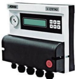
С автономным питанием. Для учета природного газа. Обслуживает два трубопровода. Для работы с преобразователями объема, имеющими импульсный выходной сигнал. Поддерживает работу с телефонными и GSM-модемами. Комплектуется фирменным ПО для дистанционного считывания данных и интегрирования в автоматизированные системы. Используется в составе измерительных комплексов ЛОГИКА 7742.
