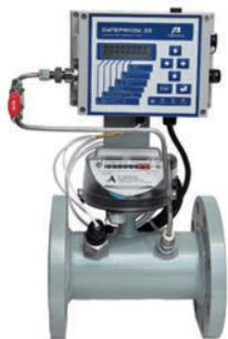
Комплекс предназначен для измерения объема природного газа в рабочих условиях и автоматического приведения измеренного объема газа к стандартным условиям в зависимости от давления, температуры и коэффициента сжимаемости газа.
