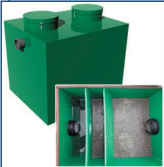
Жиросепаратор предназначен для отделения жиров растительного и животного происхождения от хозяйственно-бытовых и промышленных сточных вод. Предотвращает засоры внутренних и наружных канализационных труб. Выполнен из полипропилена/полиэтилена. Варианты исполнения: под мойку, подземные и наземные. Производительность – 0,5–90 м<sup>3</sup>/час.
