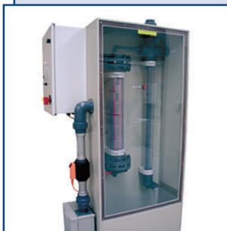
Системы на базе установок SELCOPERM предназначены для получения низкоконцентрированного раствора гипохлорита натрия методом электролиза водного раствора поваренной соли. Соответствуют требованиям нормативно-технической документации, в т. ч. «Правил безопасности производств хлора и хлорсодержащих сред».
