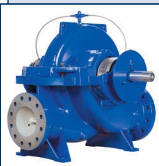
Горизонтально или вертикально устанавливаемые одноступенчатые насосы с рабочим колесом двухстороннего входа имеют спиральный корпус с продольным разъемом.
