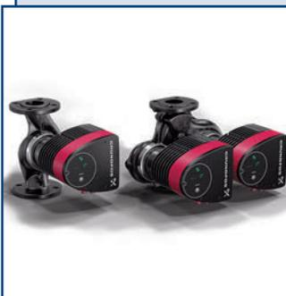
Область применения: в системах отопления; системах горячего водоснабжения; системах охлаждения; системах кондиционирования; системах, использующих теплоту грунта; системах, использующих солнечную энергию. Подача – до 70 м<sup>3</sup>/ч (для сдвоенных – до 120 м<sup>3</sup>/ч). Напор – до 18 м. Температура перекачиваемой жидкости – от -10 до +110 °С.
