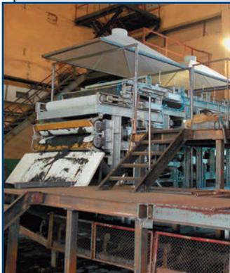
Производство ленточных фильтров-прессов типа ЛФ-П и в комплекте со сгустителем типа ЛФ-С производительностью от 1 до 100 м<sup>3</sup>/ч.
