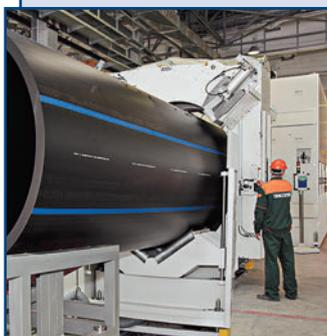
Впервые в России производство напорных полиэтиленовых труб диаметром 1400 и 1600 мм для водоснабжения и канализации на оборудовании немецкой компании battenfeld-cincinnati. Широкий диапазон типоразмеров: диаметры 800, 900, 1000, 1200, 1400, 1600 мм; SDR 9–33 в соответствии с ГОСТ 18599-2001 и ТУ 2248-005-54432486-2010. Изготовление полиэтиленовых труб с классом давления и толщиной стенки, выходящими за границы ГОСТ 18599-2001.
