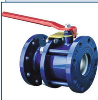
Разборная конструкция корпуса позволяет осуществлять ремонт и горячую замену основных деталей (уплотнений, шара и др.), тарельчатая пружина компенсирует износ уплотнительных элементов и тепловое расширение запорного органа.
