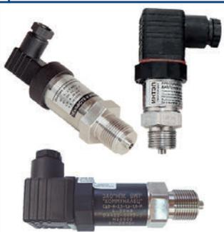
Преобразователи давления СДВ-И, ПДТВХ, Корунд, НТ предназначены для пропорционального преобразования значения избыточного давления газов и жидкостей в унифицированный электрический выходной сигнал в системах контроля и управления давлением.
