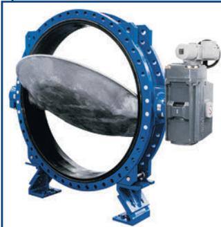
Центрический дисковый затвор с кольцевой вставкой из эластомера. Применяется с понижающим редуктором, электрическим, гидравлическим приводом и приводом с грузовым возвратом. U-образный корпус / корпус с двойными фланцами без выступающей кромки. Соединения по EN, ASME, JIS.
