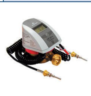
Компактный теплосчетчик ELF-m представляет собой электронный вычислитель и два датчика температуры Pt-500, выполненные в едином корпусе с тахометрическим счетчиком расхода.
