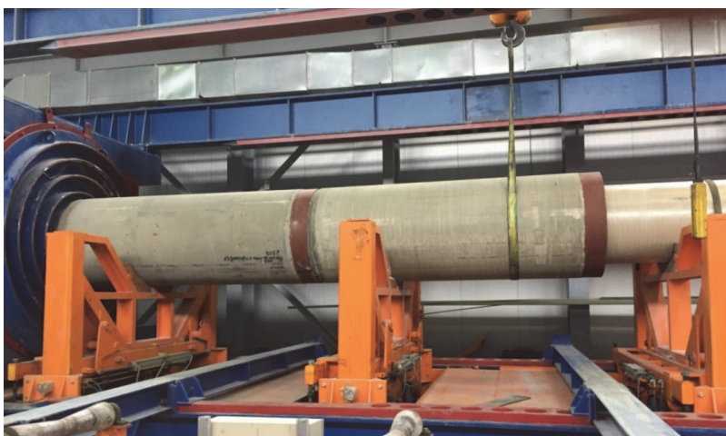
Рисунок 2. Испытание труб гидростатическим давлением
