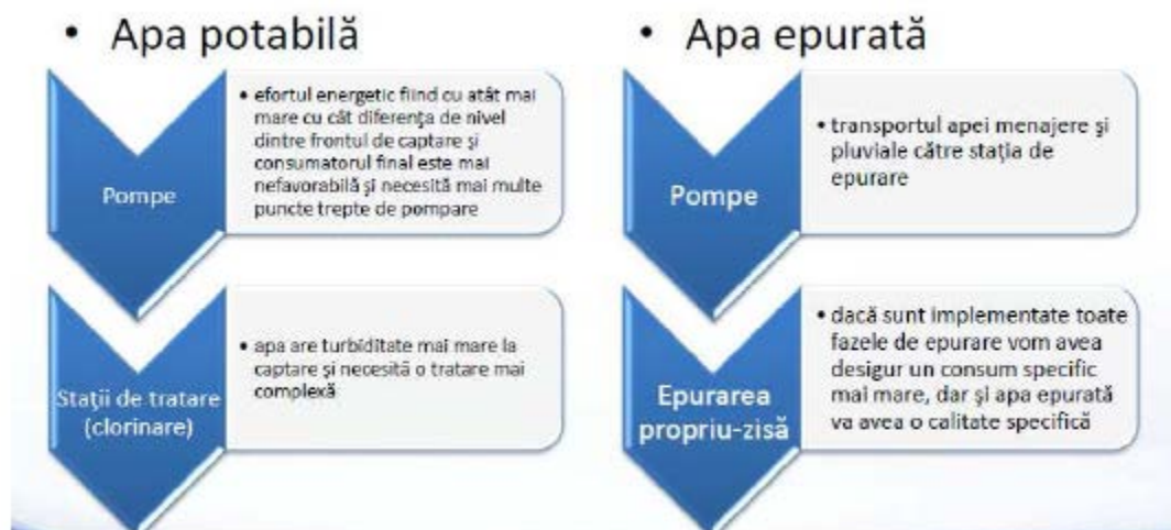
Figura 8. Factorii care influențează consumul specific de energie electrică
