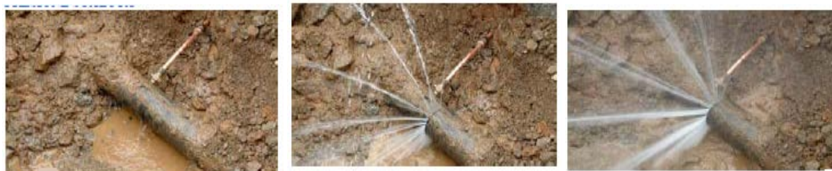
Figura 7. Pierderi de apă în condiții de: 1) presiune joasă; 2) presiune medie; 3) presiune mare
